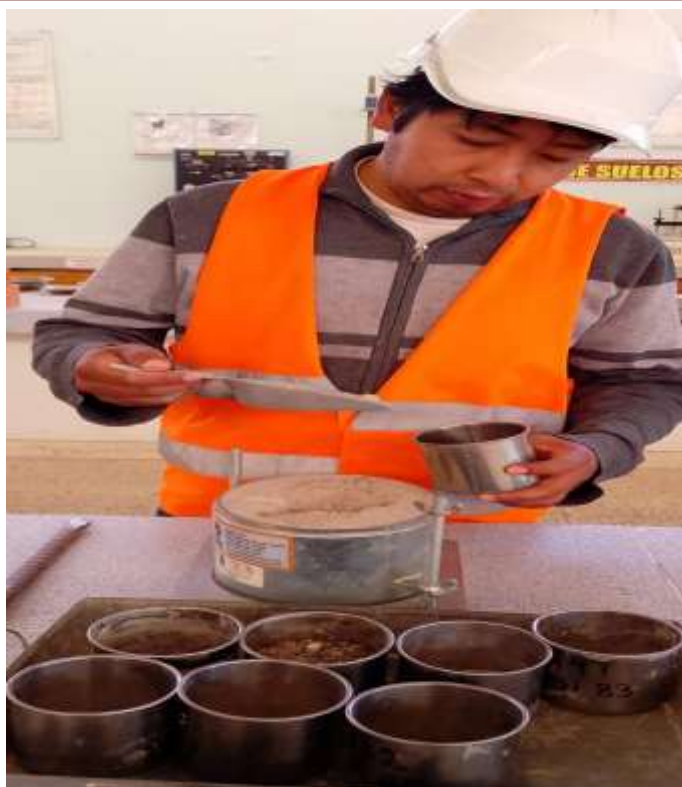
Fotografía 9. Dosificación de materiales para el ensayo Proctor
