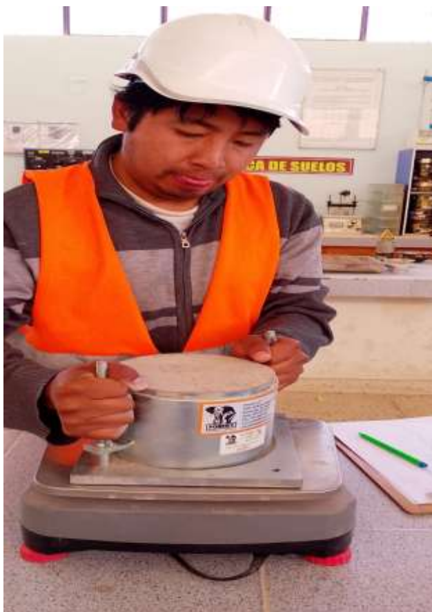
Fotografía 8. Preparación para el ensayo de Proctor
