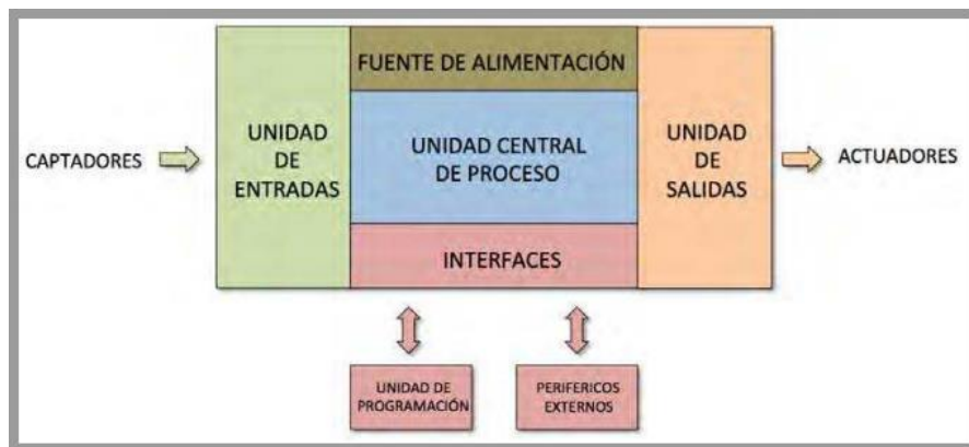
Figura 16 Arquitectura básica de un PLC
