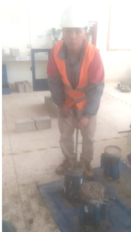
Fotografía 12. Colocado y varillado de mezcla fresca en moldes de briqueta
