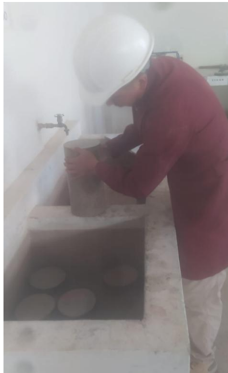
Fotografía 14. Proceso de curado de briquetas
