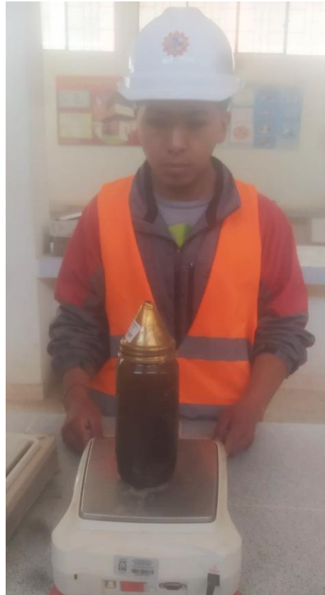
Fotografía 3. Picnómetro para ensayo de pesos unitarios
