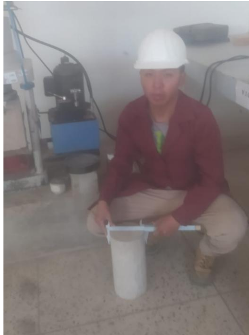
Fotografía 15. Medición de briquetas para su posterior rotura
