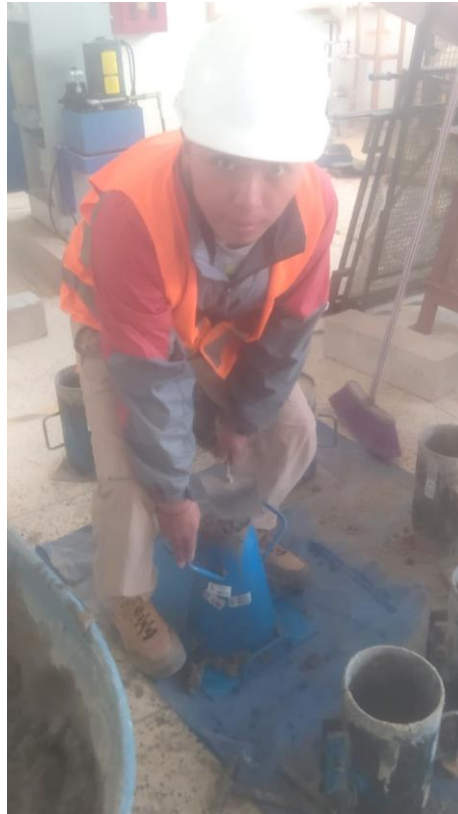
Fotografía 9. Colocado de mezcla fresca al cono de Abrams para determinación del Slump
