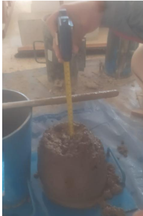
Fotografía 11. Medición del asentamiento de la mezcla con residuos de caucho
