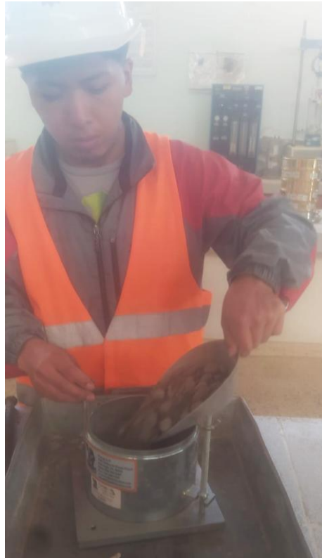
Fotografía 5. Llenado de agregados para varillado y enrasado
