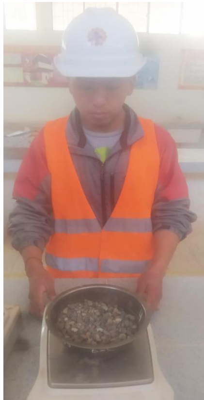
Fotografía 2. Pesaje de materiales retenidos en cada tamiz
