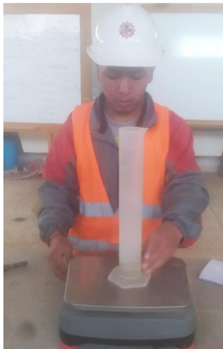
Fotografía 6. Pesado de agua para la adición a la mezcla
