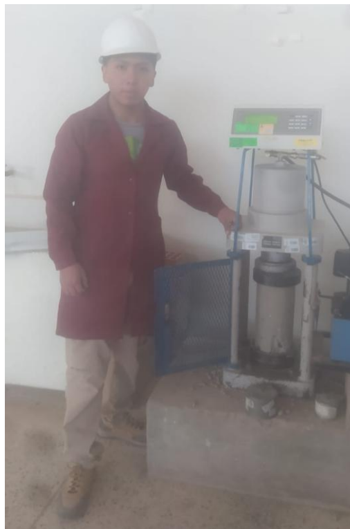
Fotografía 16. Rotura de briquetas de concreto en prensa hidráulica
