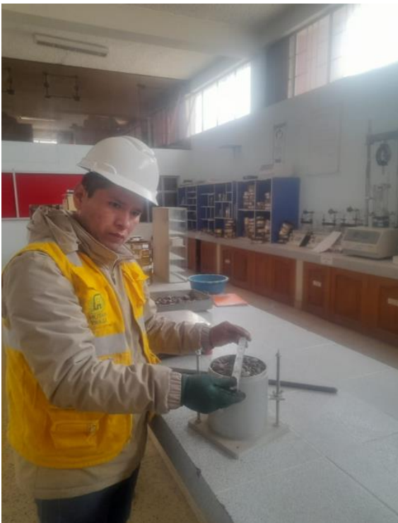
Fotografía 4. Peso unitario suelto y varillado del agregado
