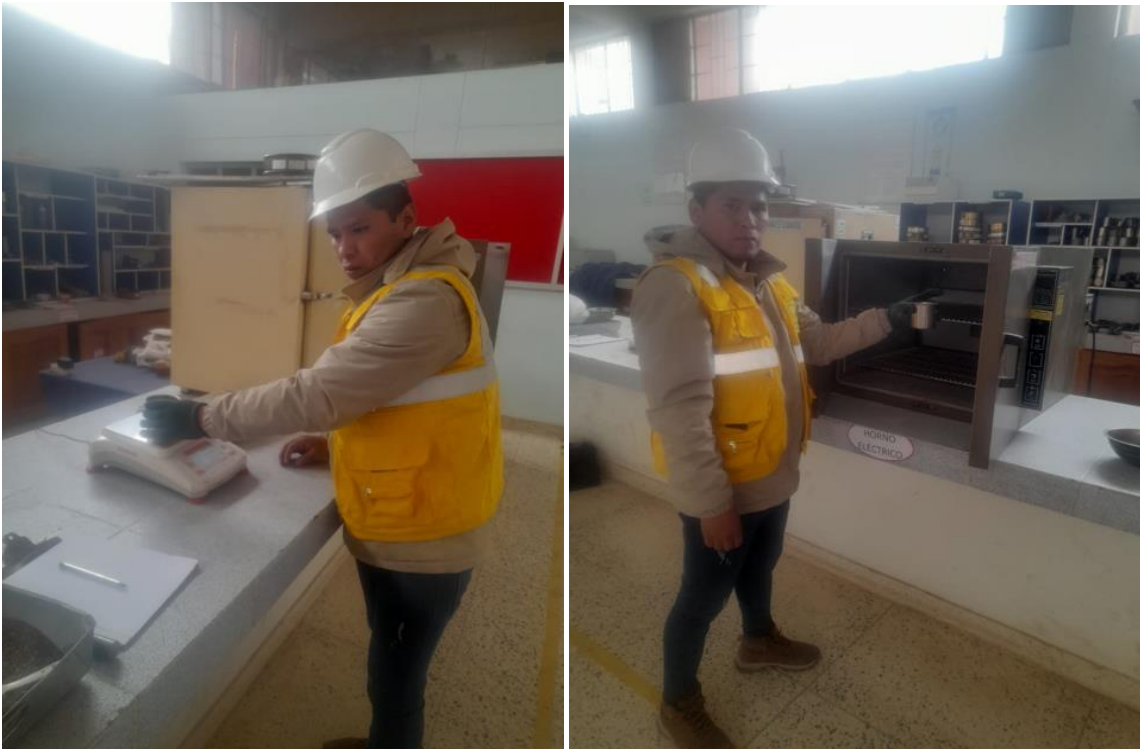
Fotografía 1. Contenido de humedad
