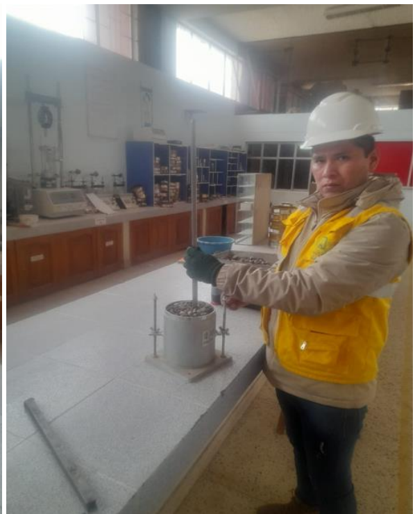
Fotografía 4. Peso unitario suelto y varillado del agregado
