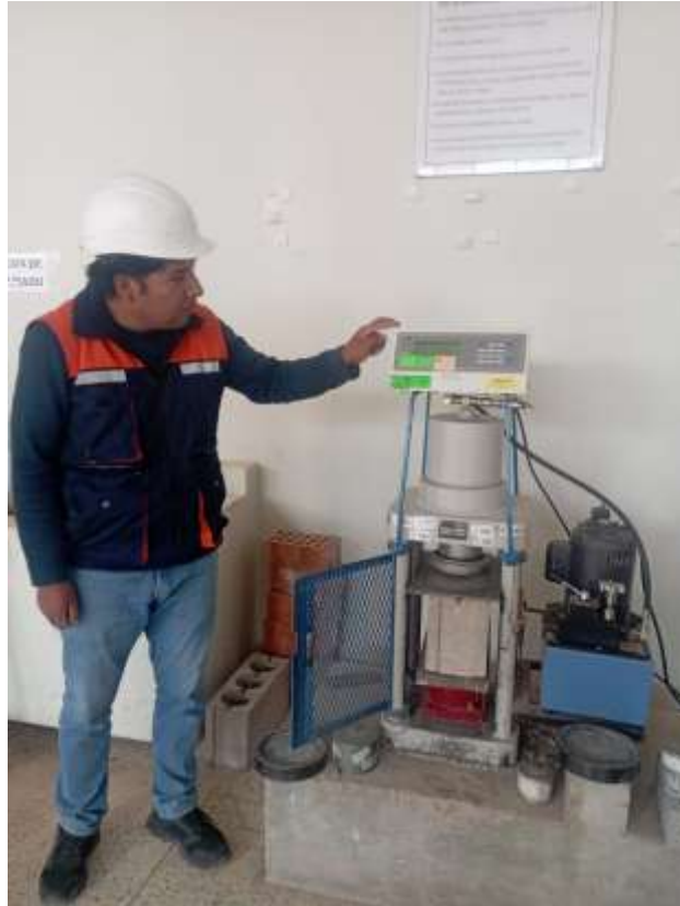
Fotografía 13. Aplicación de cargas para la rotura de bloquetas.
