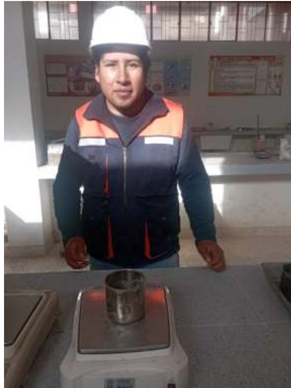
Fotografía 1. Pesaje para la determinación de humedad
