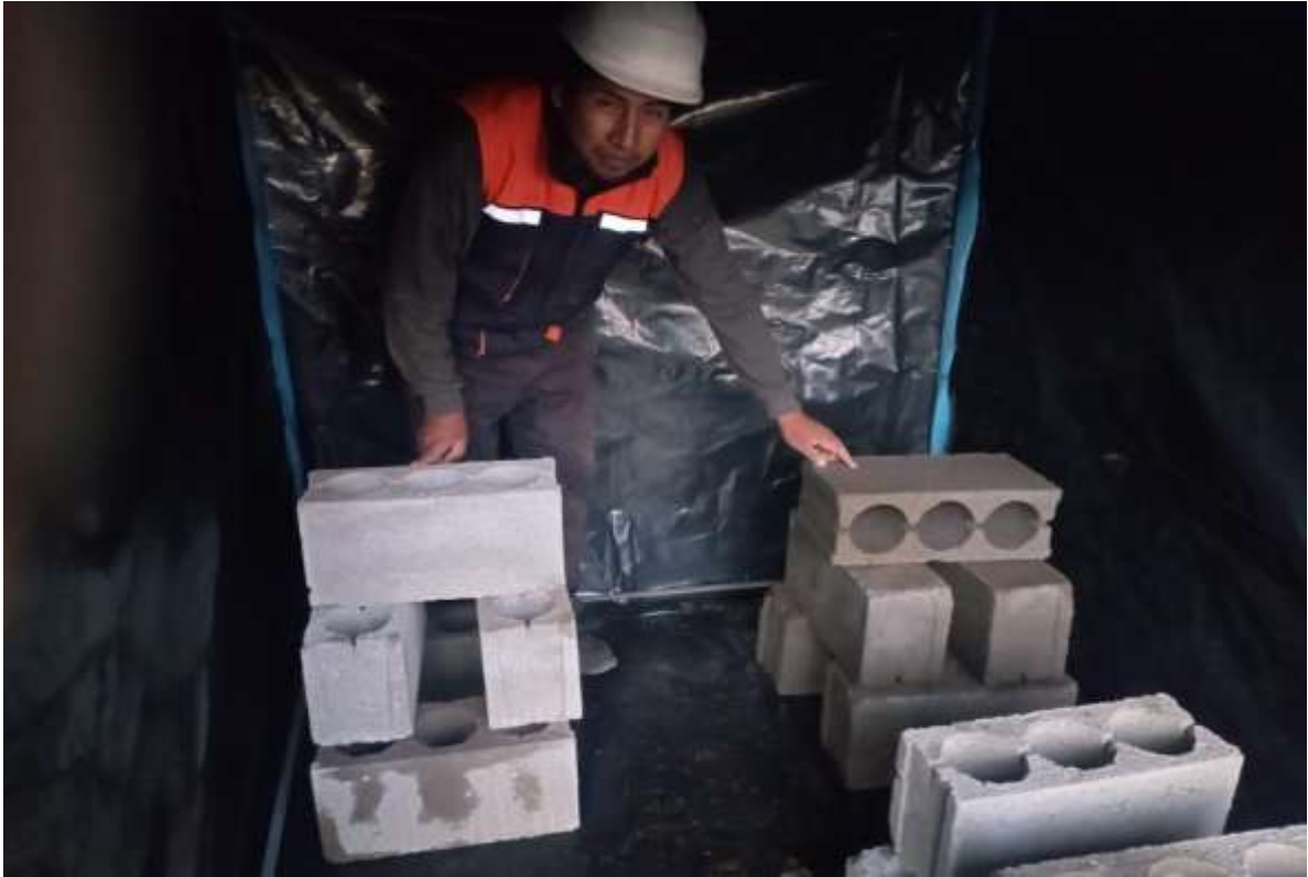
Fotografía 7. Bloques en cámara de calor.
