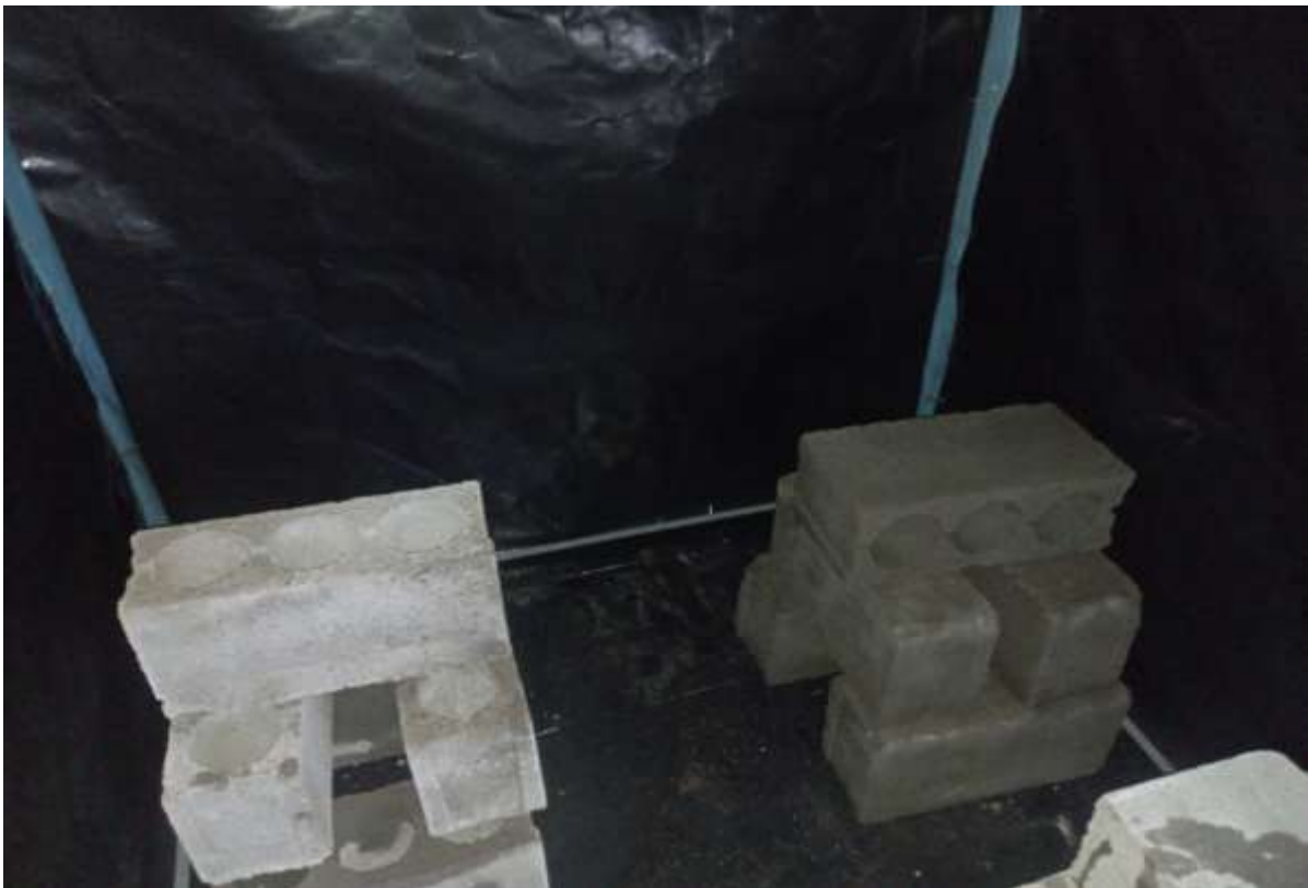
Fotografía 8. Bloques en cámara de calor.
