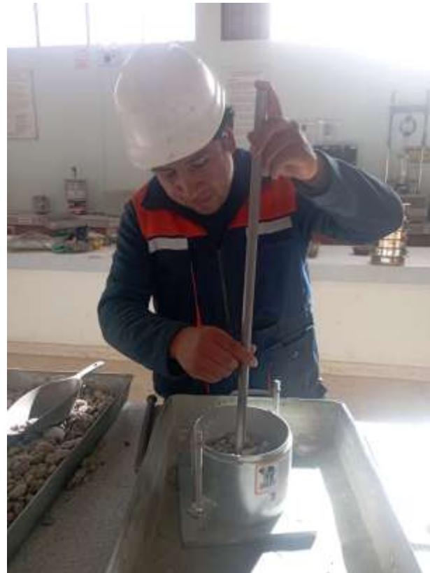
Fotografía 6. Peso varillado del agregado
