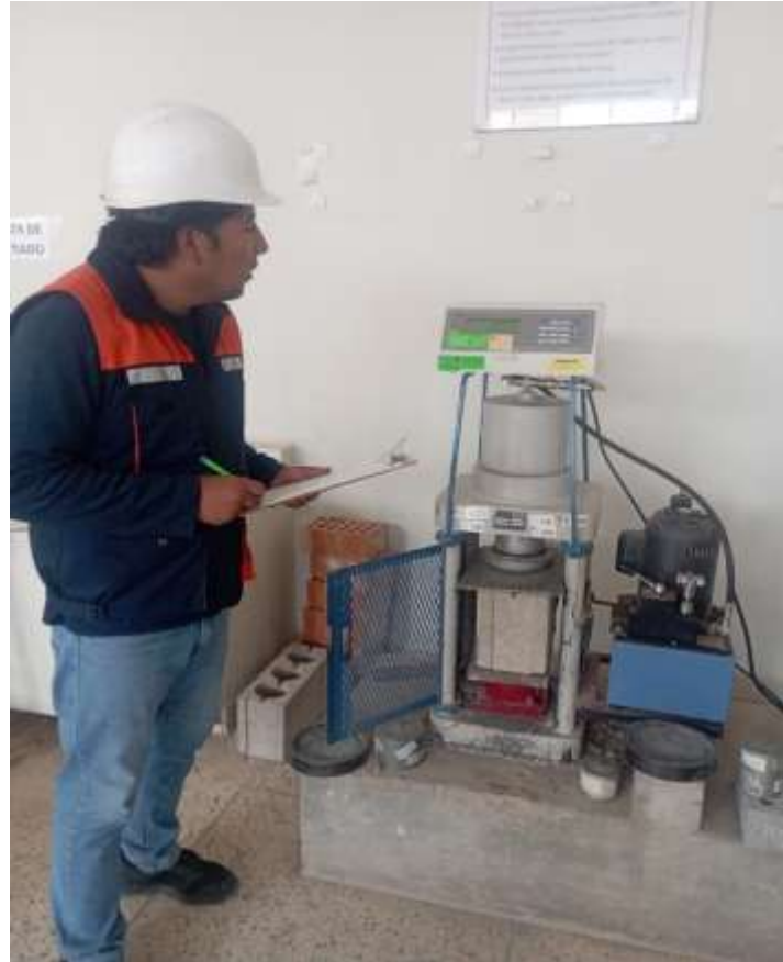
Fotografía 15. Apunte sobre la carga final de la rotura de bloquetas
