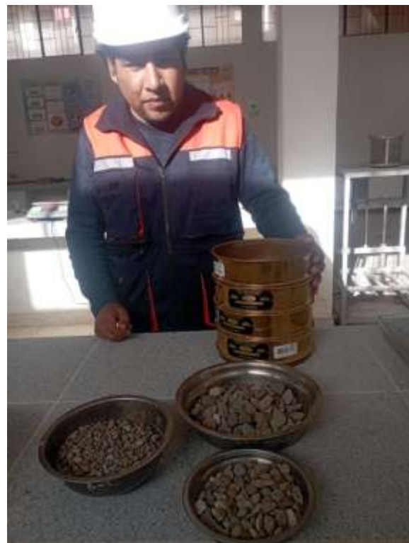
Fotografía 2. Tamizado de los agregados
