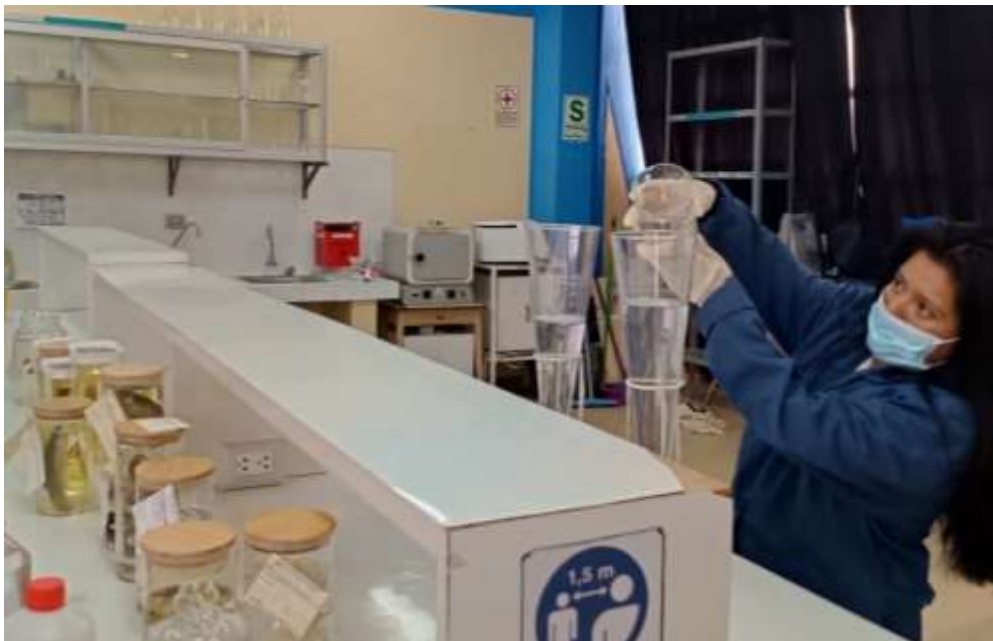
Fotografía 4. Muestra de 1.0 L de agua para medir los sólidos suspendidos totales (SST), mediante el método gravimétrico, en el Laboratorio de Ecología Acuática de la Universidad Nacional del Altiplano.
