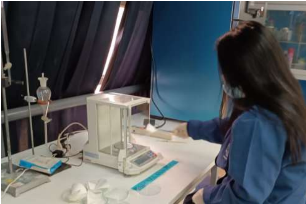
Fotografía 5. Filtros contenidos de sedimentos, llevado a una estufa a 105°C hasta peso constante.
