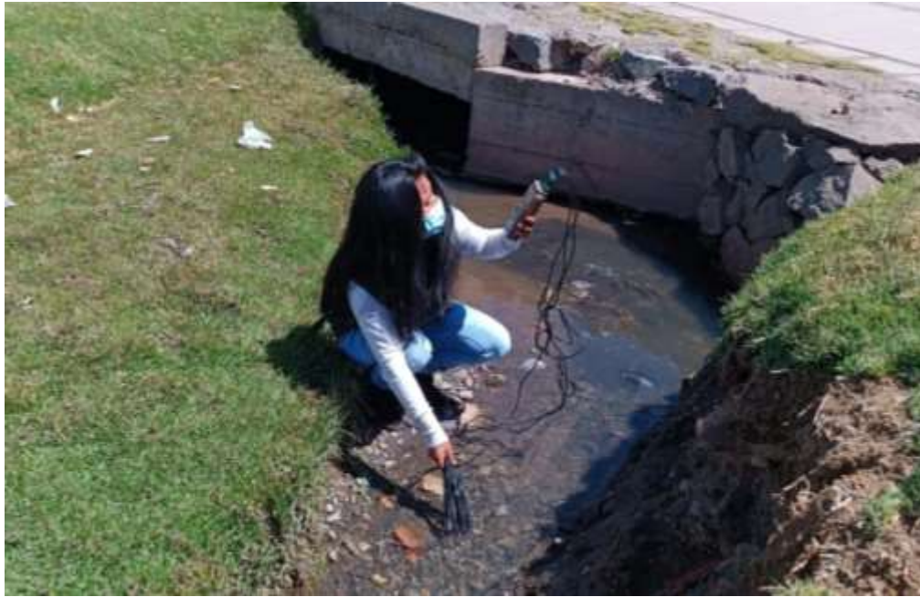
Fotografía 3. Medición de los parámetros fisicoquímicos en campo en los puntos de descarga, oxígeno disuelto (OD), pH, conductividad y temperatura.
