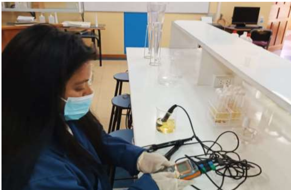
Fotografía 6. Medición de los parámetros de muestras de agua en laboratorio. Oxígeno disuelto (OD), pH, conductividad y temperatura.
