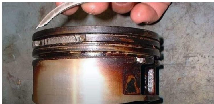
Figura 1. Desgaste de anillos y cilindro
