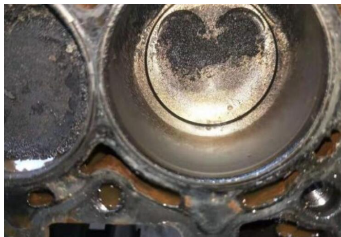
Figura 3. Desgaste de válvulas y asiento
