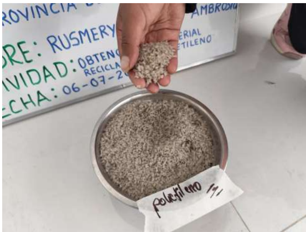
Fotografía 5. Presentación del polietileno de baja densidad.
