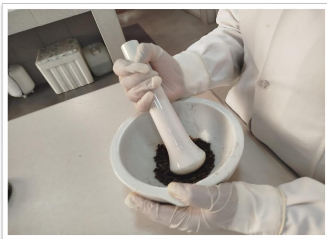
Figura 20: Moliendo la semilla con la ayuda de un mortero
