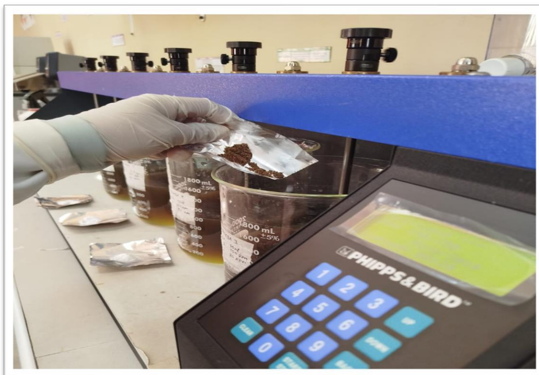
Figura 22: Aplicación del coagulante en la prueba de jarras
