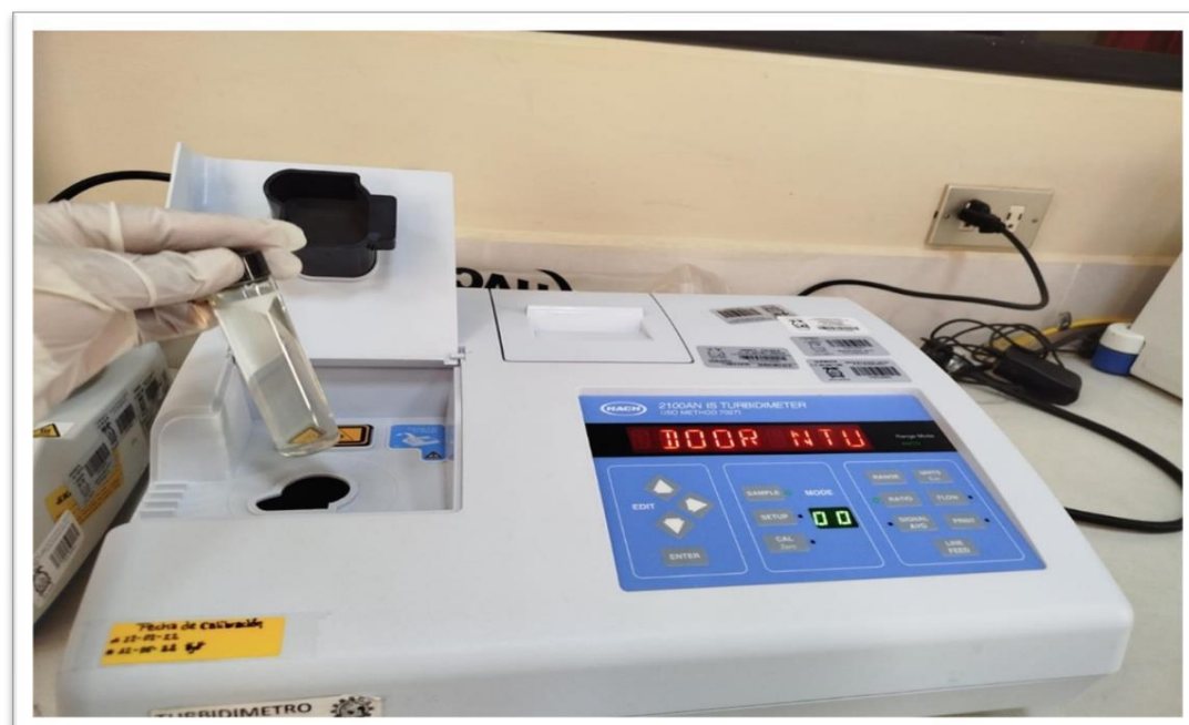
Figura 18: Medición de la turbidez después del tratamiento
