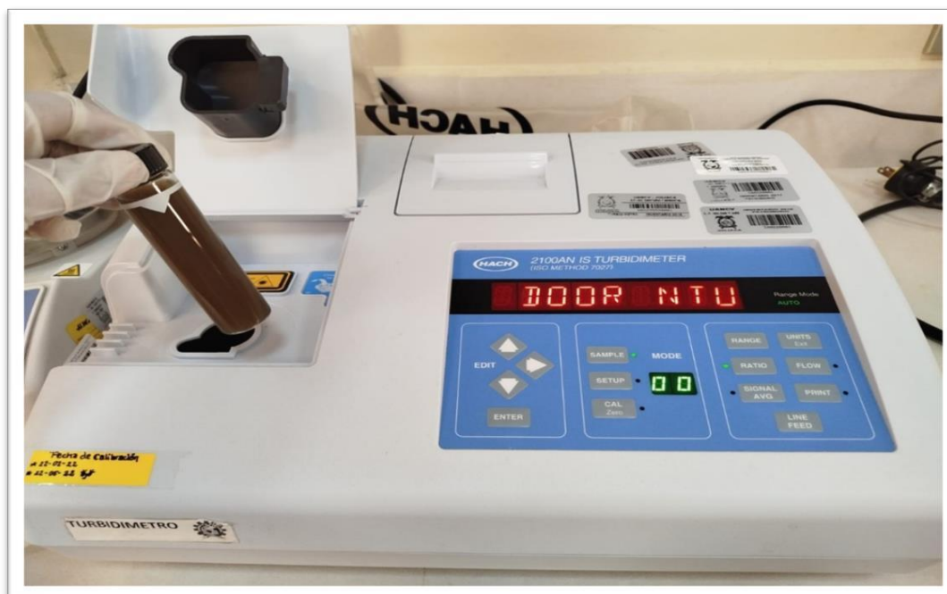
Figura 17: Medición de la turbidez inicial con el turbidímetro
