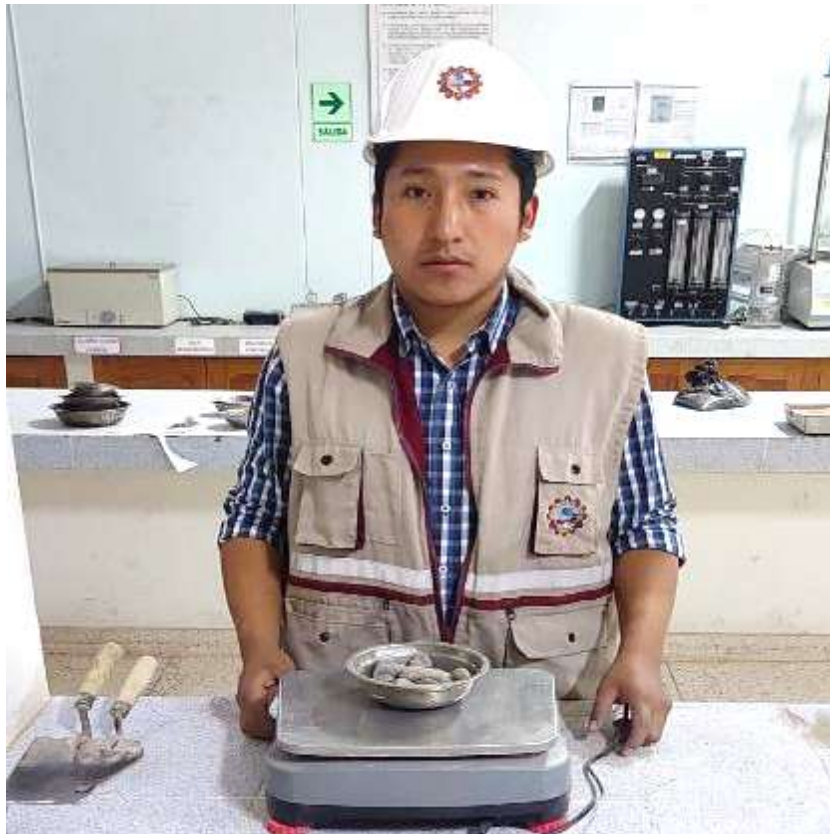
Fotografía 6 Pesado de agregado grueso del tamizado
