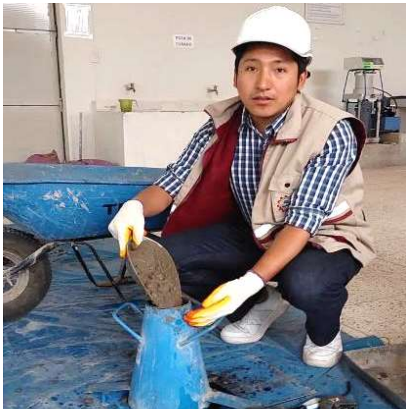
Fotografía 16 Ensayo de asentamiento paso 2
