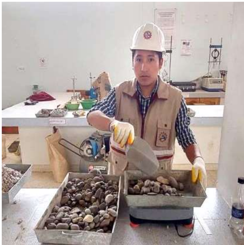
Fotografía 8 Pesaje del agregado grueso
