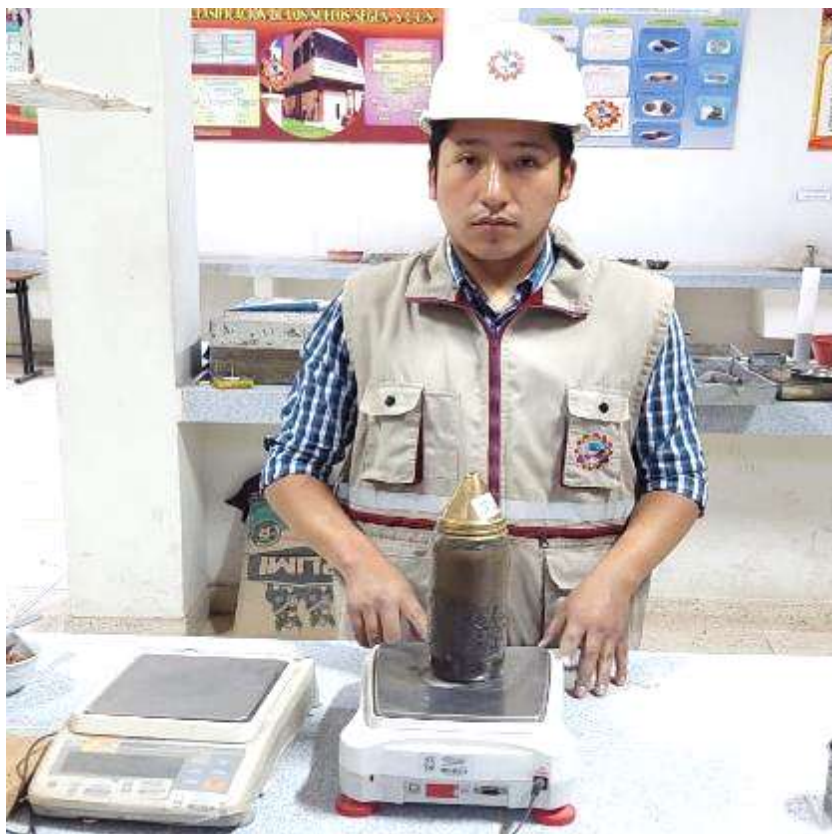
Fotografía 12 Ensayo de absorción con picnómetro
