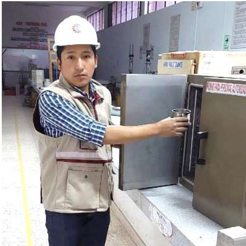
Fotografía 12 Ensayo de absorción con picnómetro
