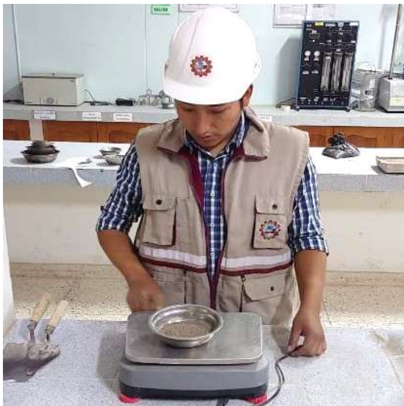
Fotografía 6 Pesado de agregado grueso del tamizado
