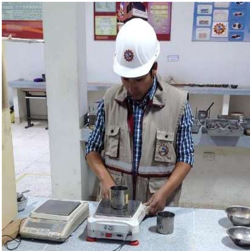
Fotografía 10 Pesajes de muestra para secado en horno
