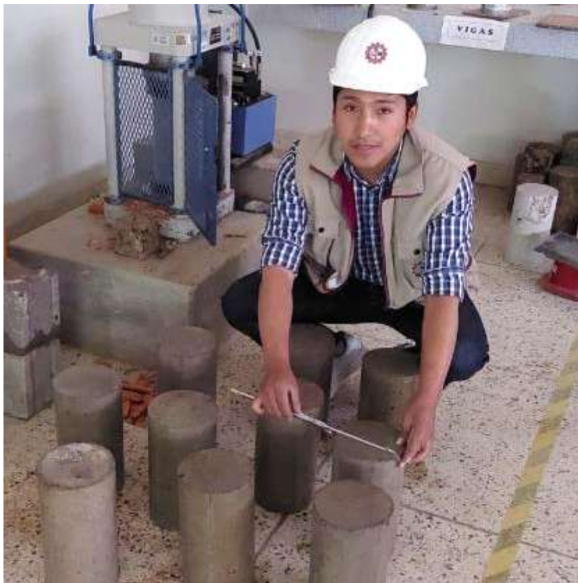
Fotografía 20 Ensayo de resistencia a la compresión paso 1
