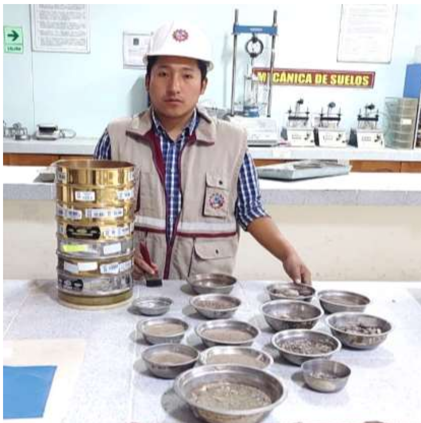
Fotografía 4 Tamizado de agregados
