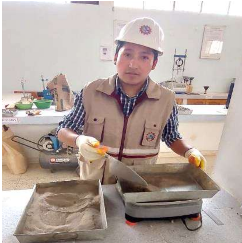
Fotografía 10 Pesajes de muestra para secado en horno
