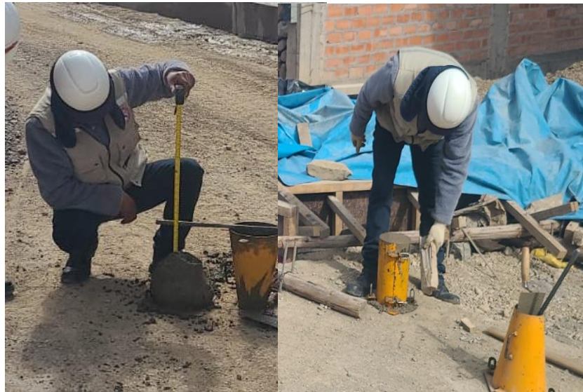
Figura 5: ensayo de slump
