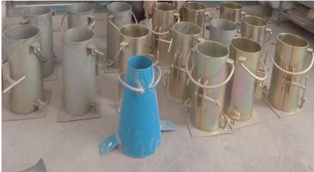
Figura 2: elaboración de probetas cilíndricas in-situ
