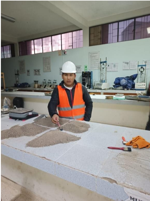
1. Cuarteamos y pesamos la muestra arena y grava
