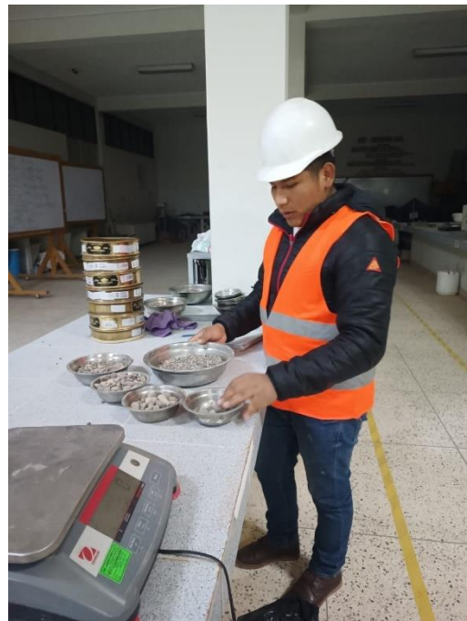
4. Separamos la muestra de cada tamiz retenido
