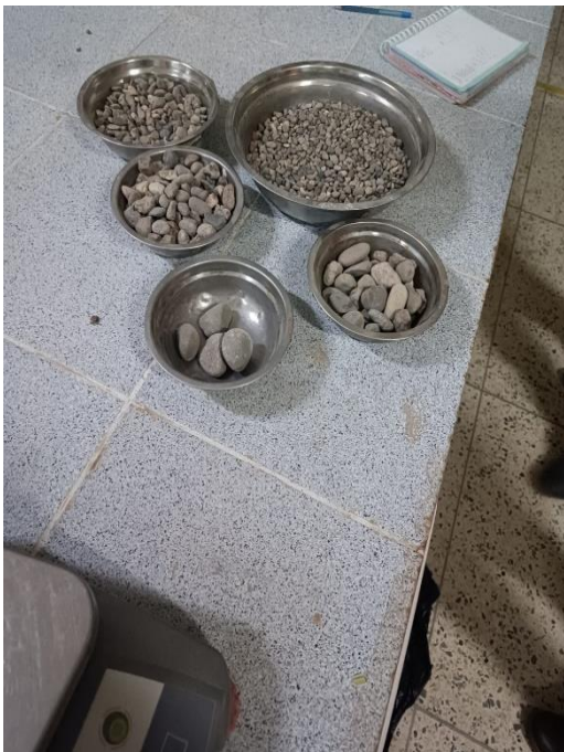
4. Separamos la muestra de cada tamiz retenido
