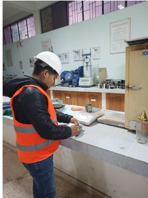
1. Cuarteamos y pesamos la muestra arena y grava
