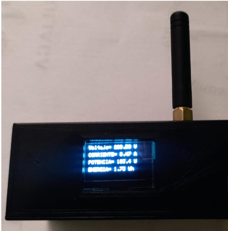
Figura 98: Prototipo Final del módulo de monitoreo
