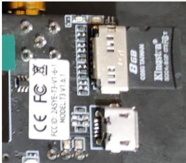
Figura 31: Implementación del módulo de SD Card
