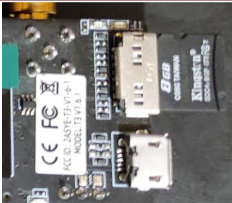
Figura 69: Implementación del módulo de SD Card
