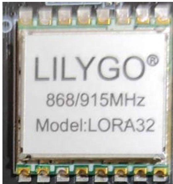
Figura 37: Implementación del módulo LoRa
