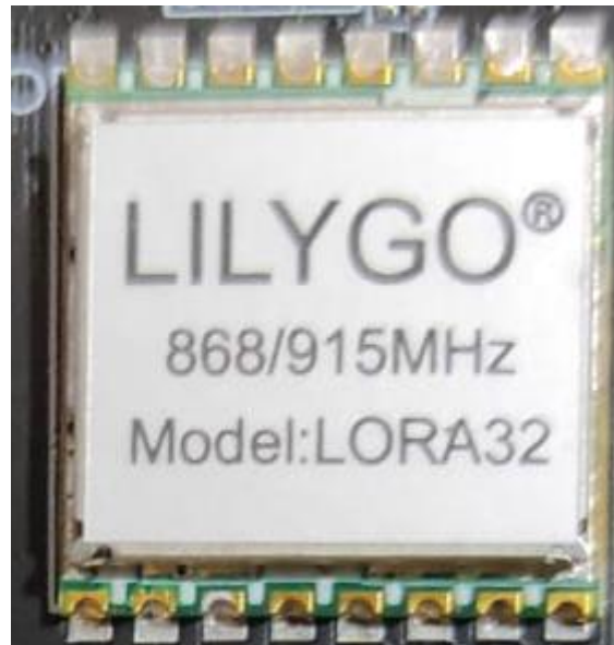
Figura 75: Implementación del módulo LoRa
