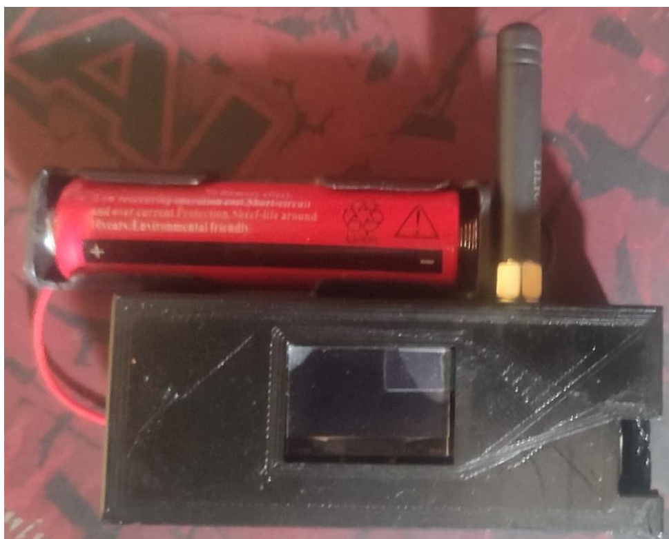
Figura 96: Segundo prototipo del módulo de centralización
