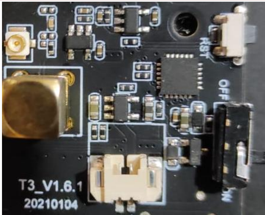
Figura 80: Implementación del módulo de carga de la batería Li-Ion
