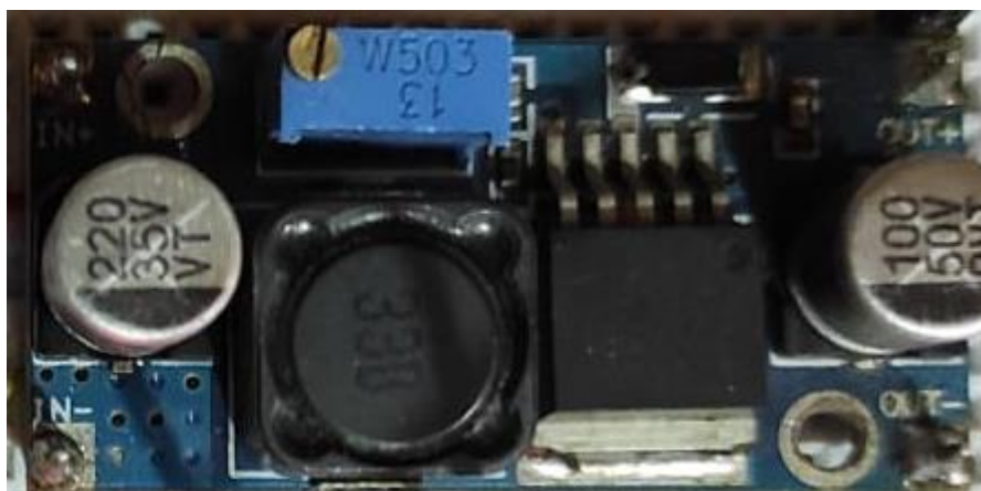
Figura 56: Implementación del módulo StepUp XL6009
