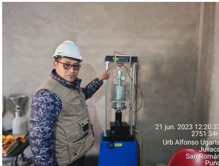
Fotografía 4. Ensayo de capacidad de soporte CBR
