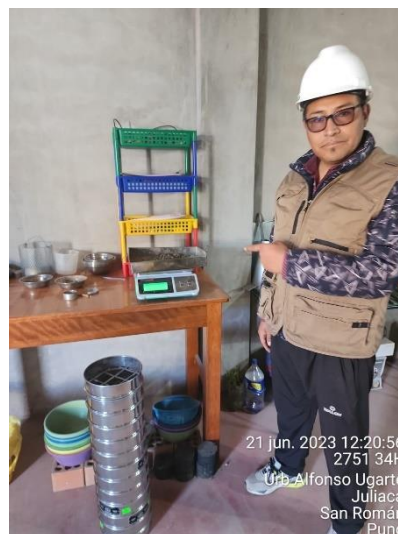
Fotografía 2. Determinación de la granulometría del material
