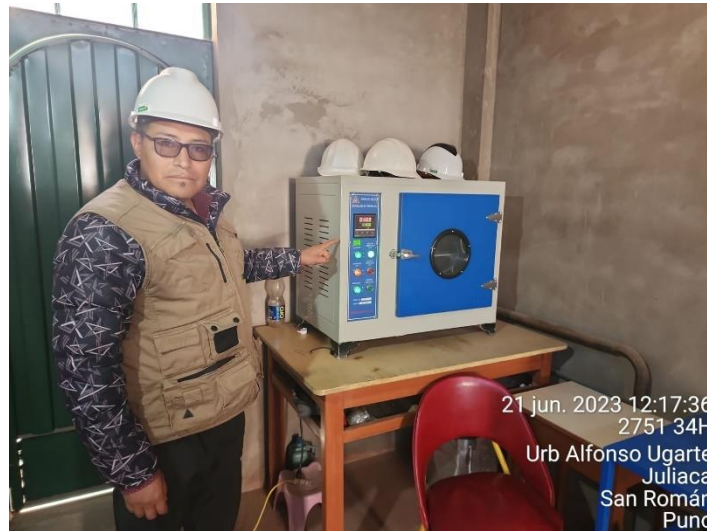
Fotografía 1. Determinación del contenido de humedad
