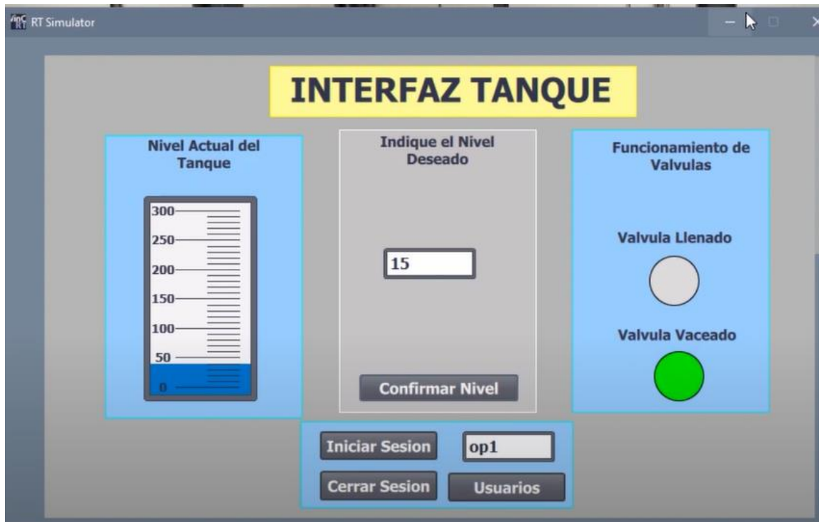
Figura 42 Vaciado a minimo del Tanque de Mezcla
