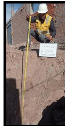
Fotografía 04 CALICATA 02 – material de relleno
