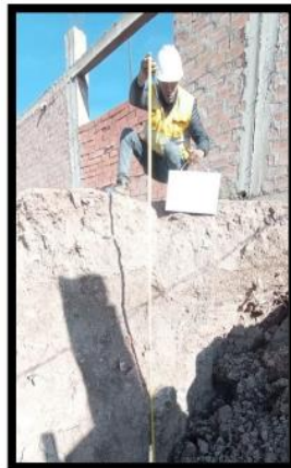
Fotografía 03 CALICATA 02 – material de relleno
