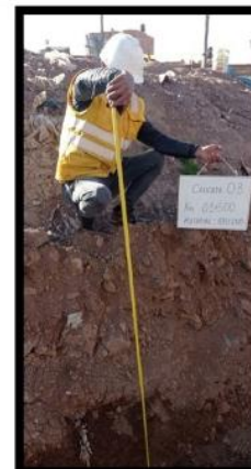
Fotografía 06 CALICATA 03 – material de relleno
