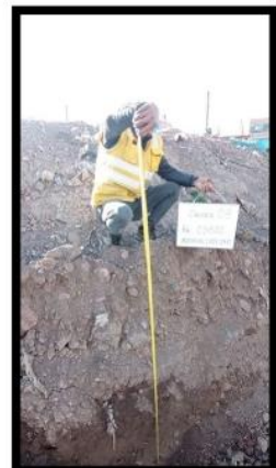
Fotografía 05 CALICATA 03 – material de relleno
