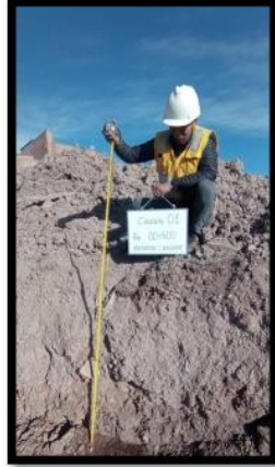
Fotografía 01 CALICATA 01 – material de relleno
