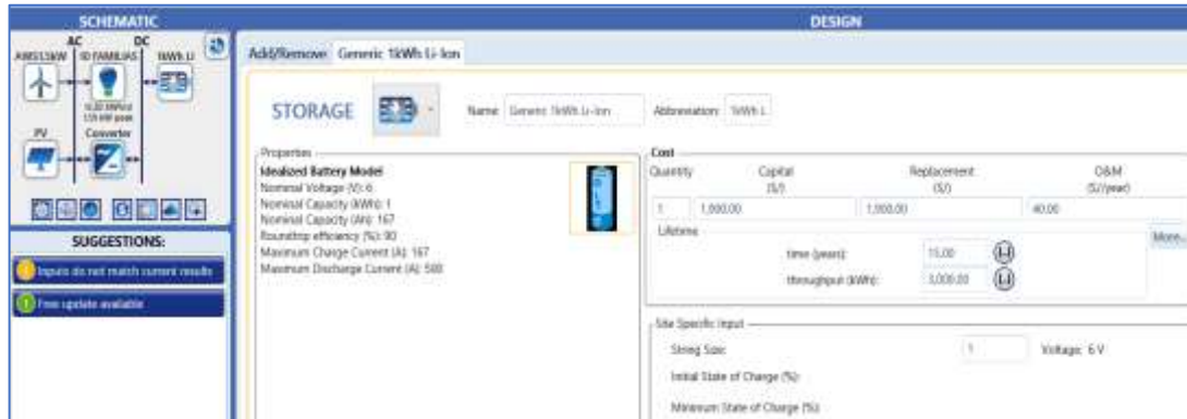
FIGURA 60. Designación de banco de baterías para el sistema
