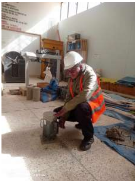
DESMOLDE DE PROBETAS
