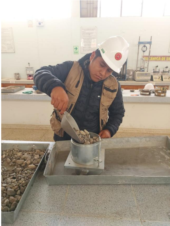
Fotografía 3. Peso volumétrico suelto y varillado
