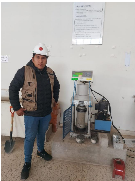
Fotografía 4. Rotura de briquetas
