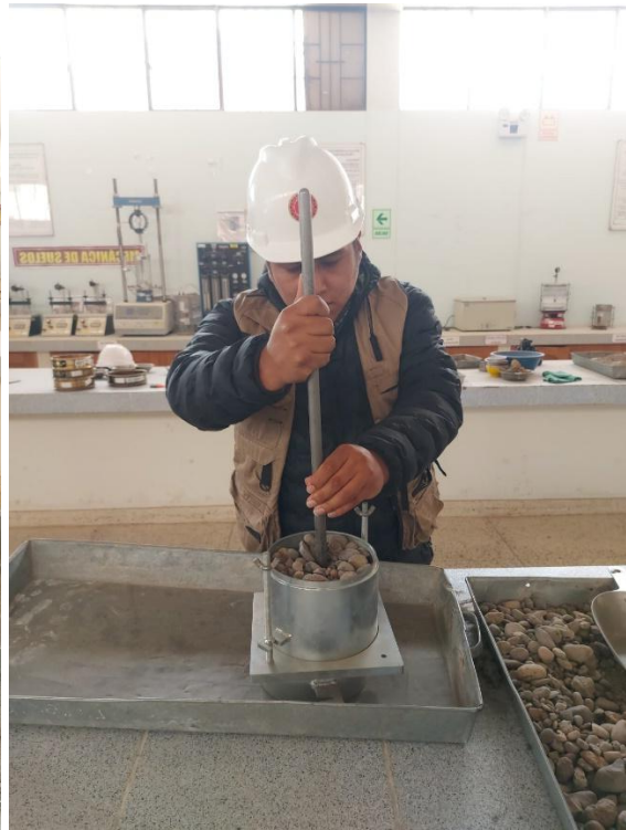
Fotografía 3. Peso volumétrico suelto y varillado
