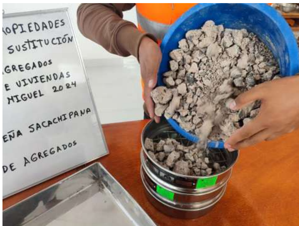
Fotografía 6. Tamizado de los agregados provenientes de la demolición de vías.
