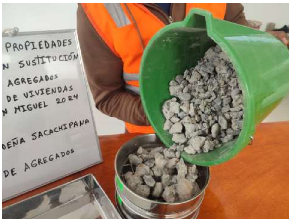
Fotografía 5. Tamizado de los agregados reciclados por la malla 1 1/2".
