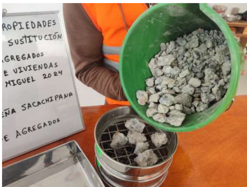
Fotografía 4. Tamizado de los agregados provenientes de la demolición de viviendas.
