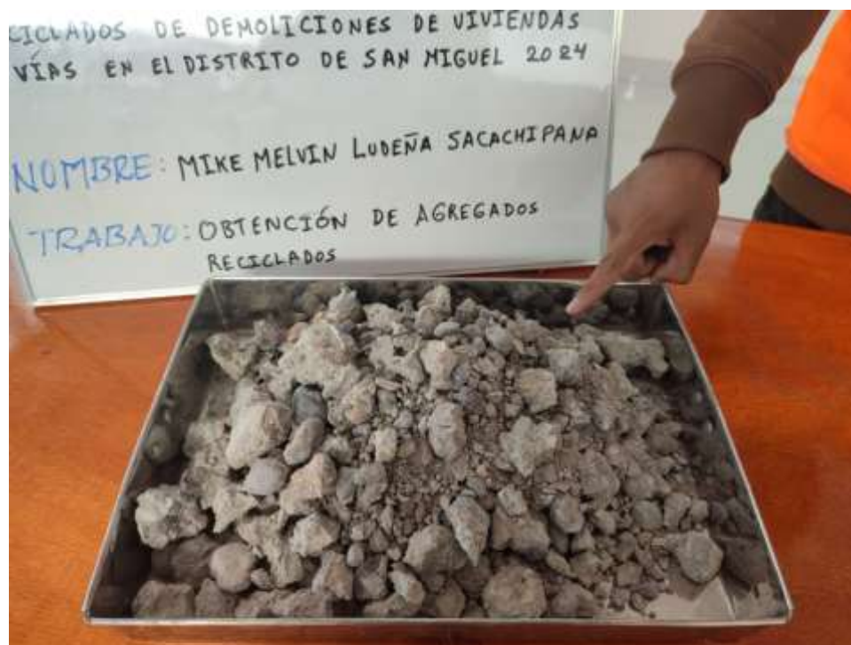
Fotografía 2. Obtención de los agregados provenientes de la demolición de viviendas.
