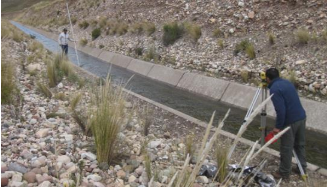
Fotografía 1. Verificación de pendiente
