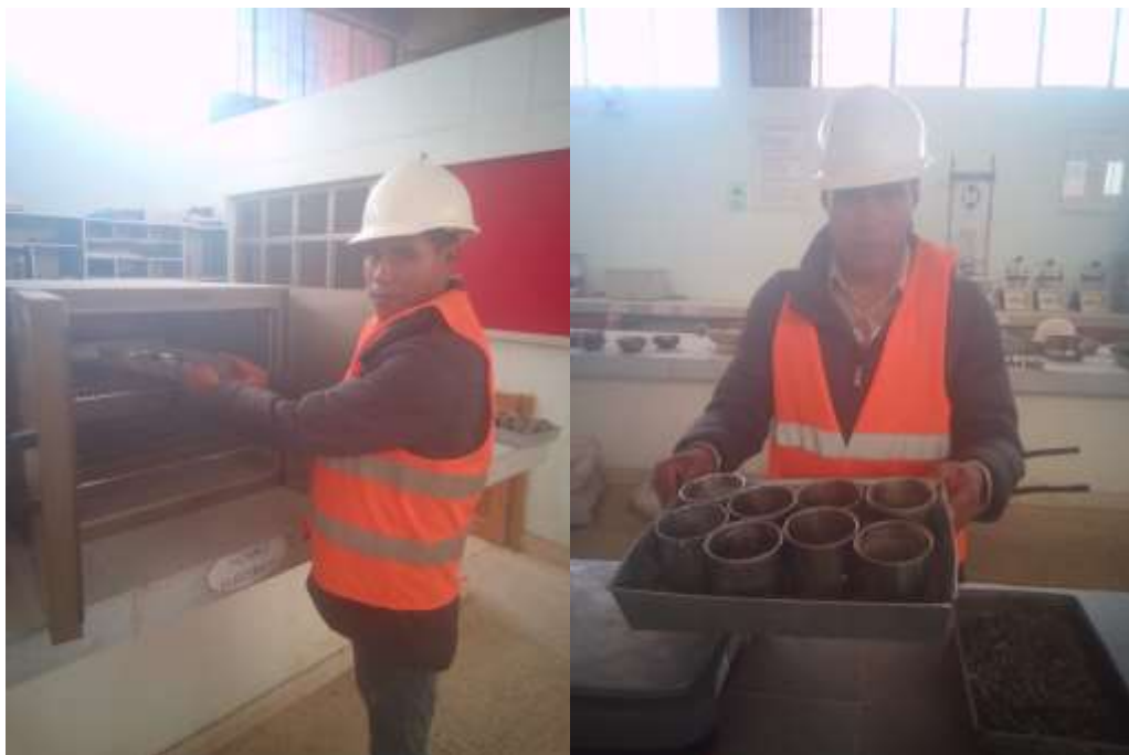
Fotografía 4. Contenido de humedad.
