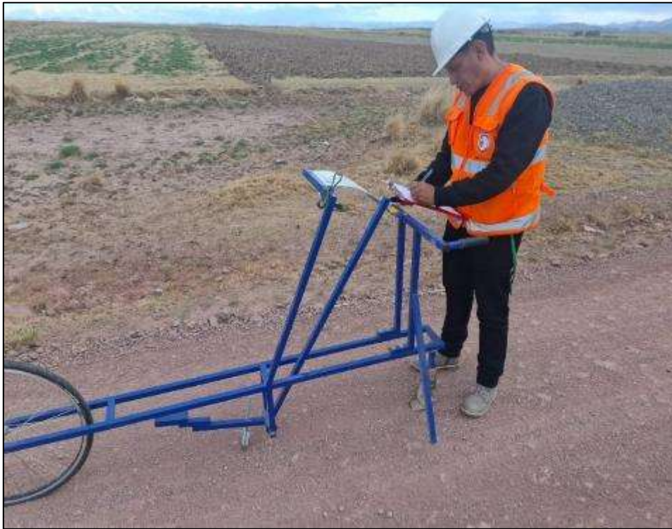
Fotografía 6. Secuencia del recorrido aplicando el equipo de Merlín.
