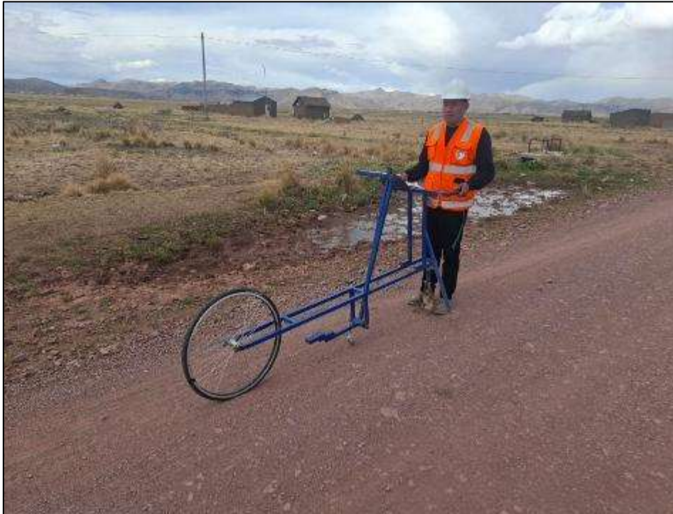
Fotografía 6. Secuencia del recorrido aplicando el equipo de Merlín.
