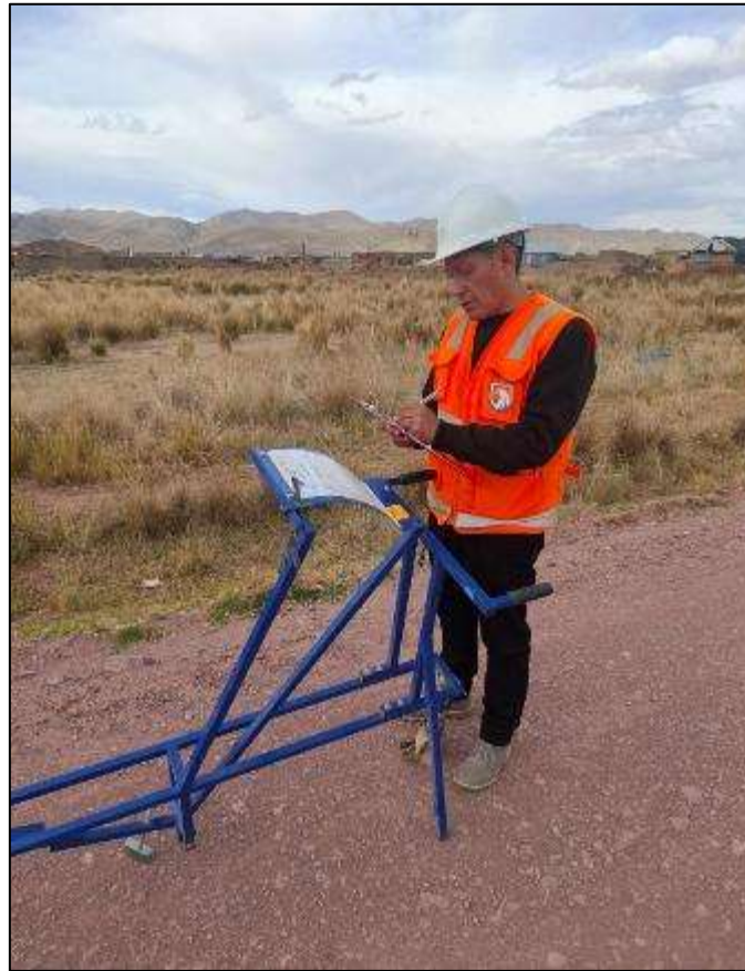
Fotografía 12. Medición de deflexiones y depresiones encontradas en la vía.
