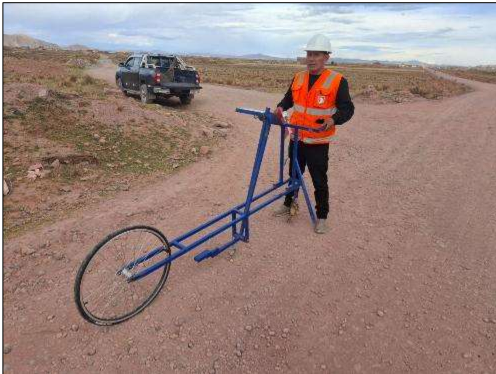
Fotografía 12. Medición de deflexiones y depresiones encontradas en la vía.
