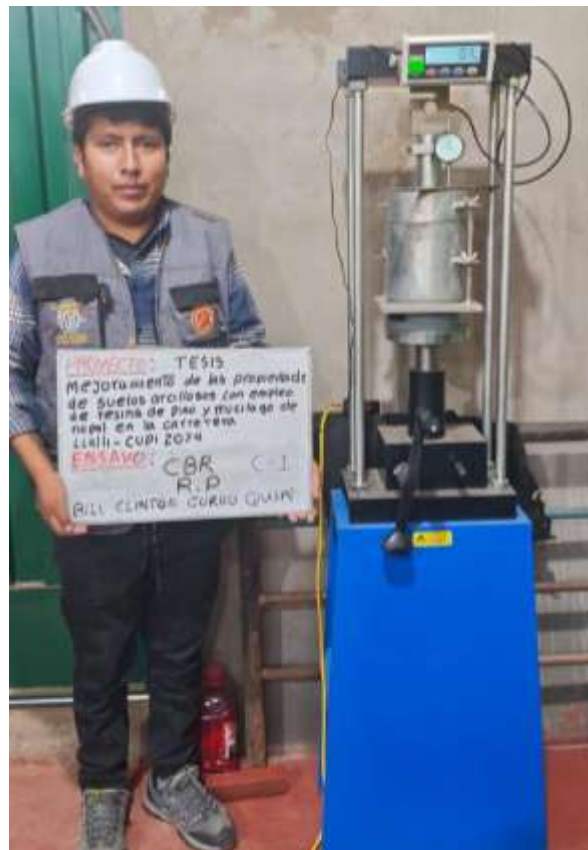
Fotografía 8. Máquina de penetración CBR
