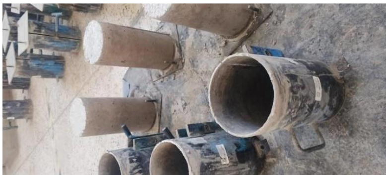
Figura 8 Desencofrado de briquetas
