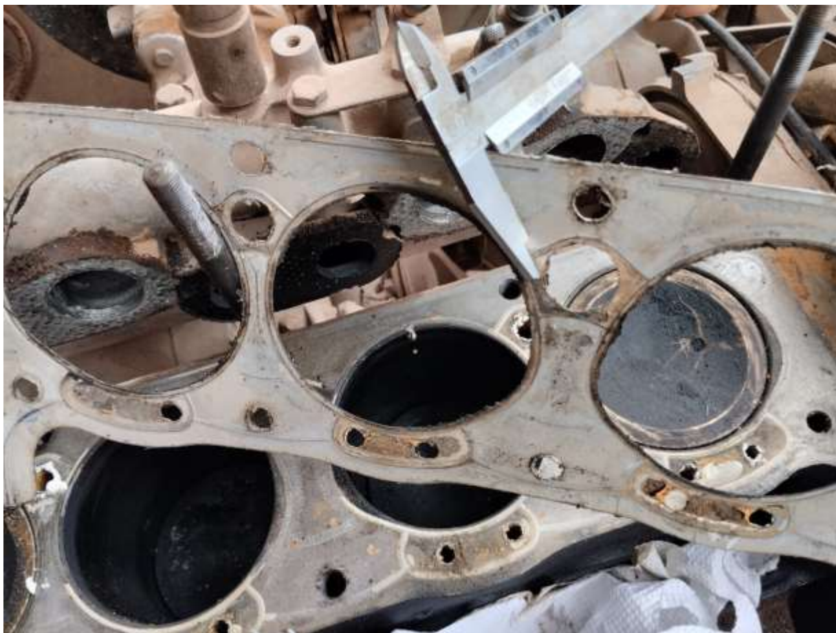
Foto 03. Medida de espesor de empaquetadura (mm).
