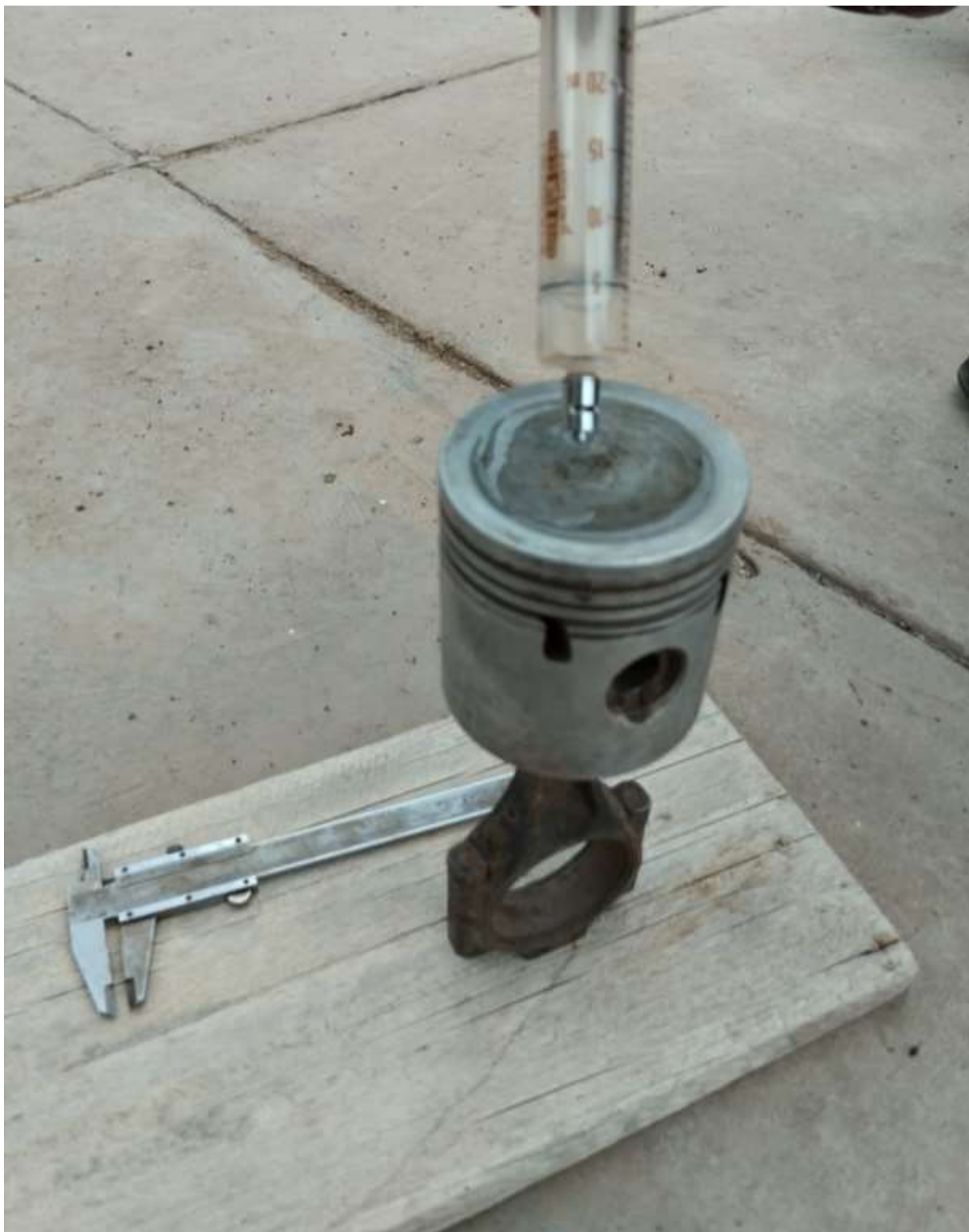
Foto 04. Medida de volumen de compresión en la cabeza del pistón (cm 3 ).
