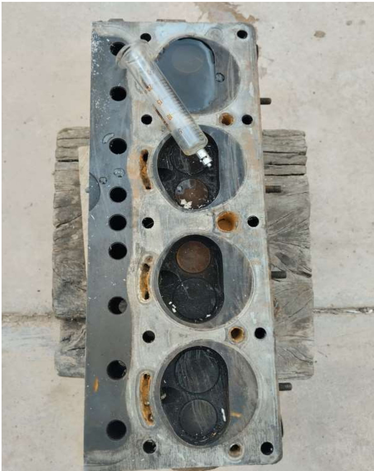
Foto 01. Medición del volumen de compresión en la base de culata(cm3).
