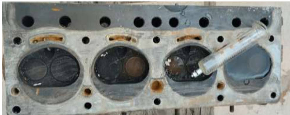
Figura 5. Vista de cámara de combustión en la culata
