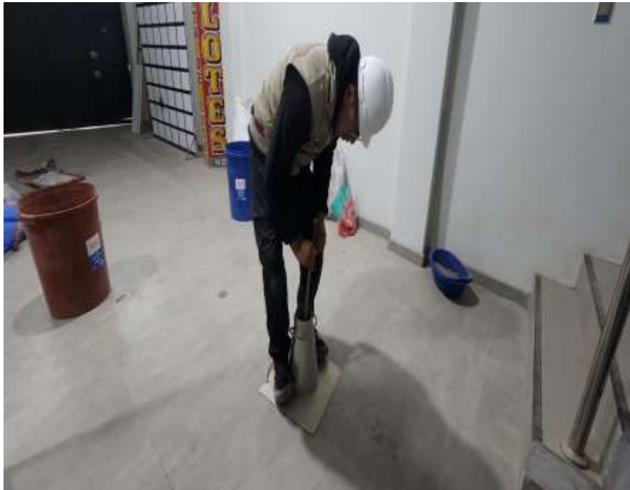
Fotografía 03. Ensayo de cono de abrams
