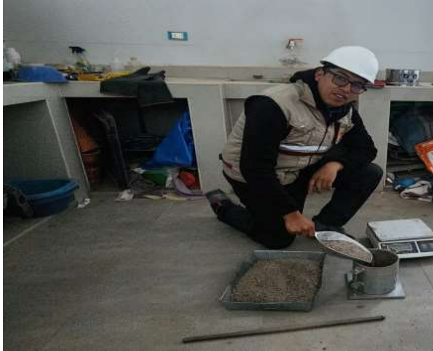
Fotografía 01. Dosificación de los agregados
