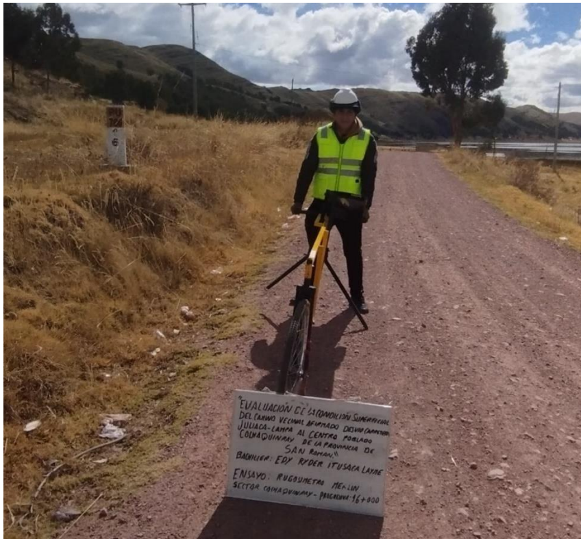
Fotografía 17. Inicio de las lecturas con el rugosímetro merlín en el km 16+000
