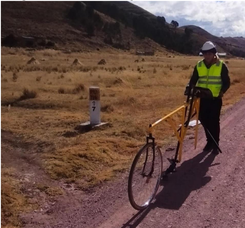
Fotografía 19. Lecturas del rugosímetro merlín en el km 17+000
