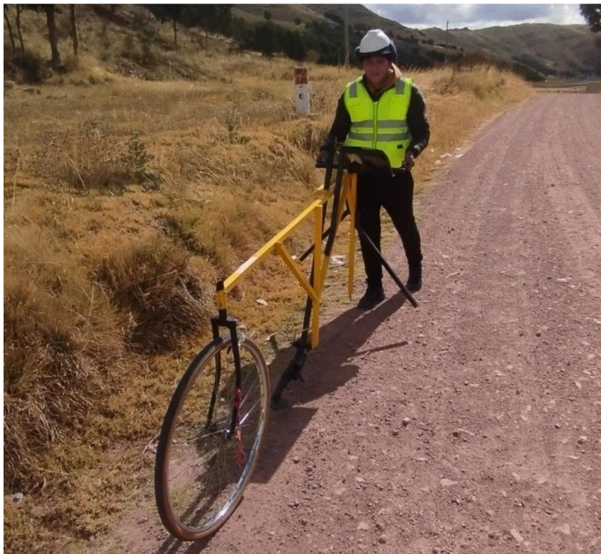
Fotografía 17. Inicio de las lecturas con el rugosímetro merlín en el km 16+000
