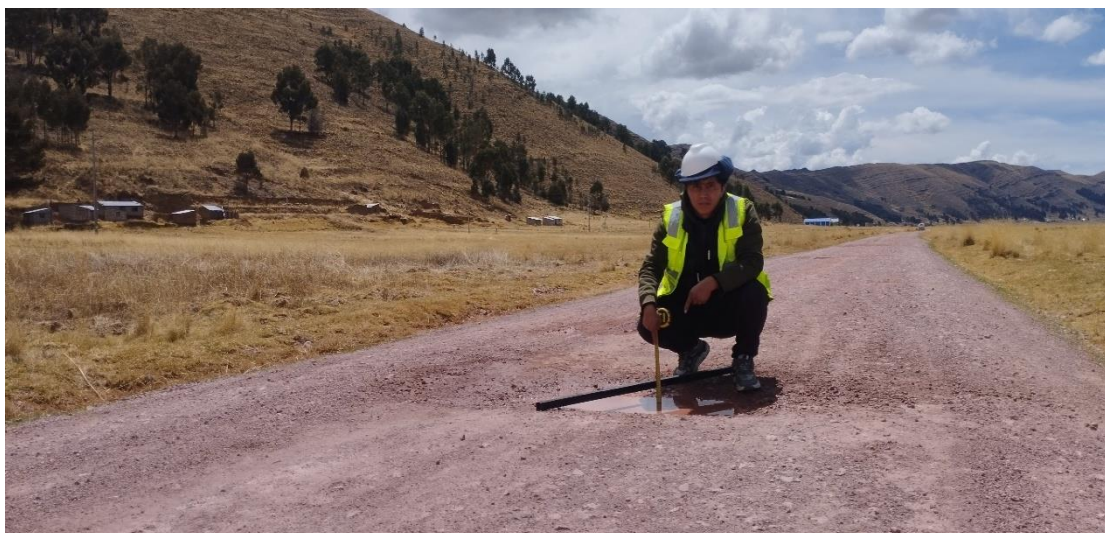
Fotografía 12. Deformación grado 3 entre el km 17+440 y el km 17+460
