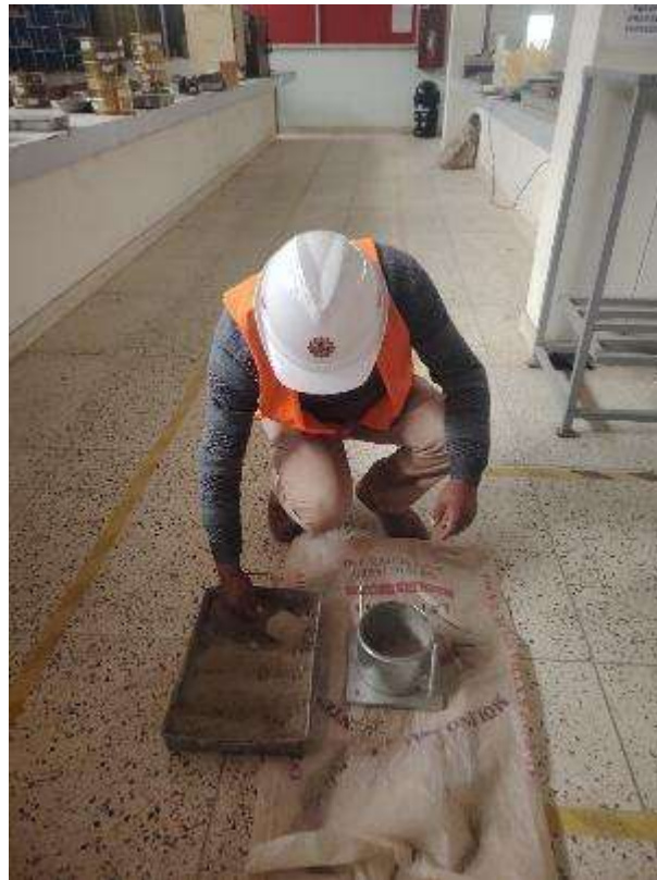
Fotografía 15. Ensayo de proctor modificado de material con sulfato de calcio hemihidratado
