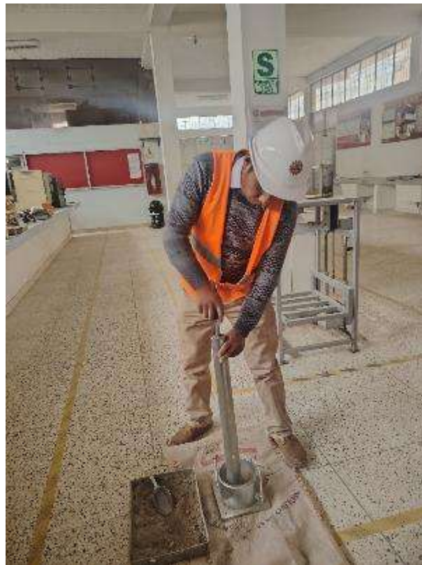
Fotografía 16. Ensayo de proctor modificado de material con cemento endurecido
