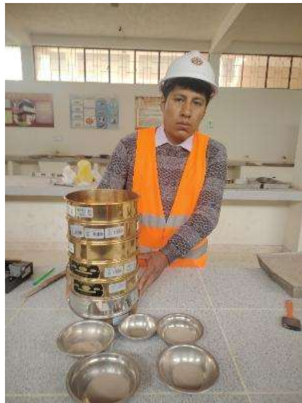
Fotografía 8. Análisis granulométrico por tamizado
