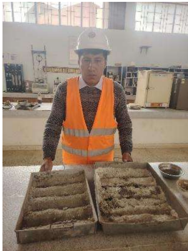
Fotografía 14. Bandejas de mezcla de suelo de subrasante con cemento y sulfato de calcio respectivamente
