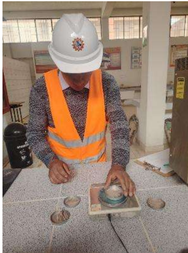
Fotografía 11. Ensayo de limite plástico
