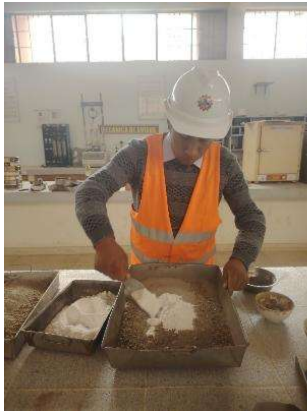
Fotografía 13. Mezcla de sulfato de calcio con muestra de suelo de subrasante
