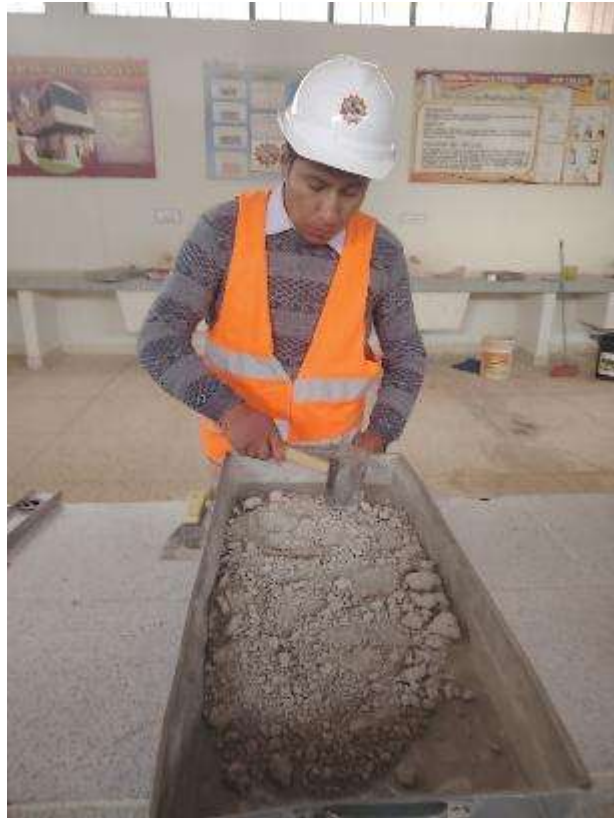
Fotografía 5. Trituración del cemento endurecido
