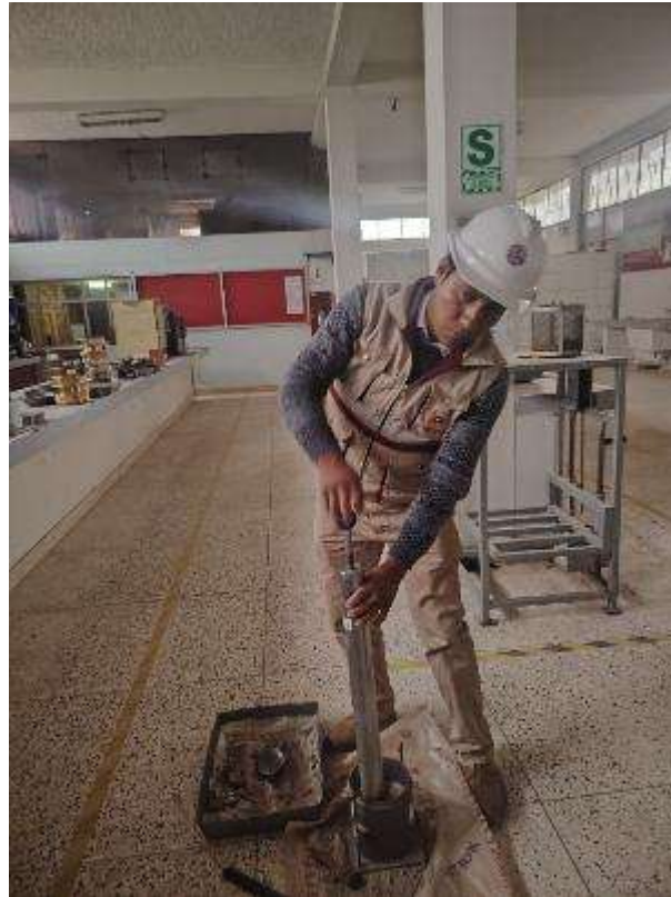
Fotografía 23. Ejecución de ensayo CBR, para ambos grupos de control
