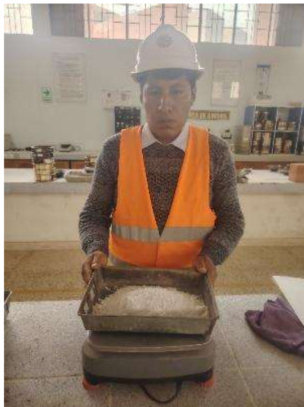
Fotografía 6. Pesaje del sulfato de calcio hemihidratado
