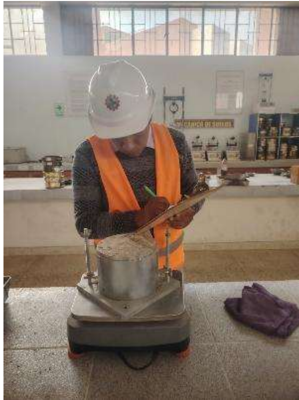
Fotografía 17. Pesaje de muestras compactadas para su registro
