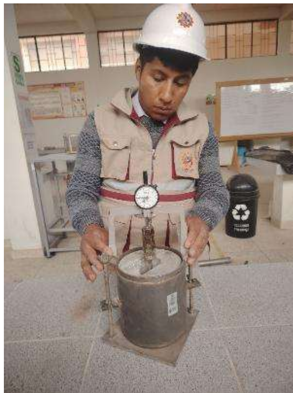
Fotografía 24. Sujeción de dial de control de penetración sobre molde de CBR
