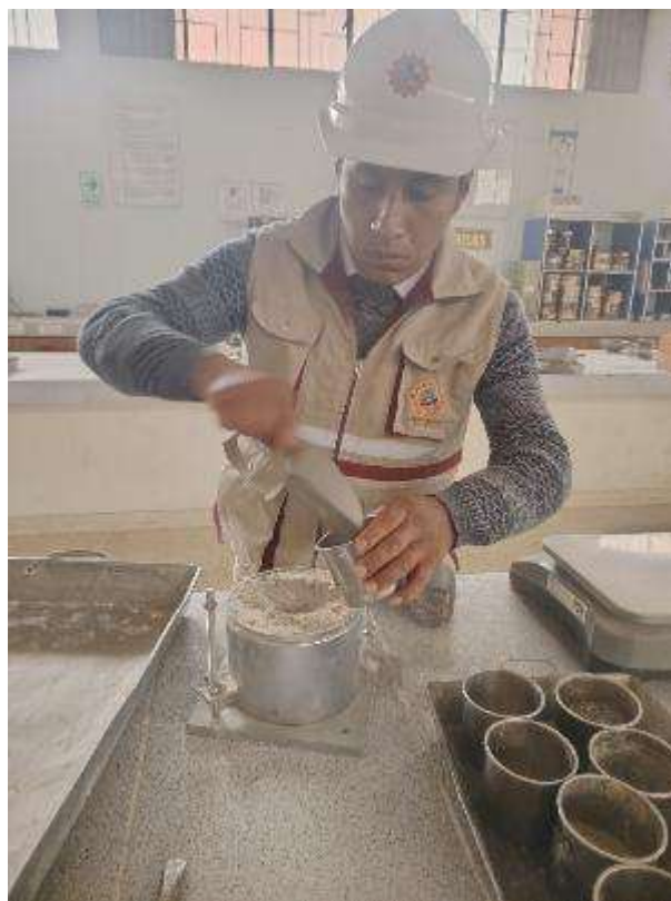
Fotografía 18. Extracción de muestra representativa para determinación de contenido de humedad y su relación con la máxima densidad seca
