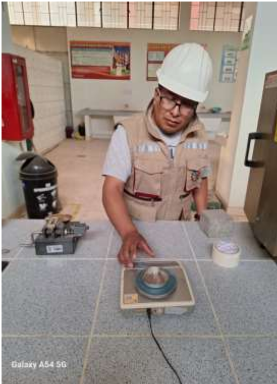
Fotografía 8. Ensayo en laboratorio-Limite plástico
