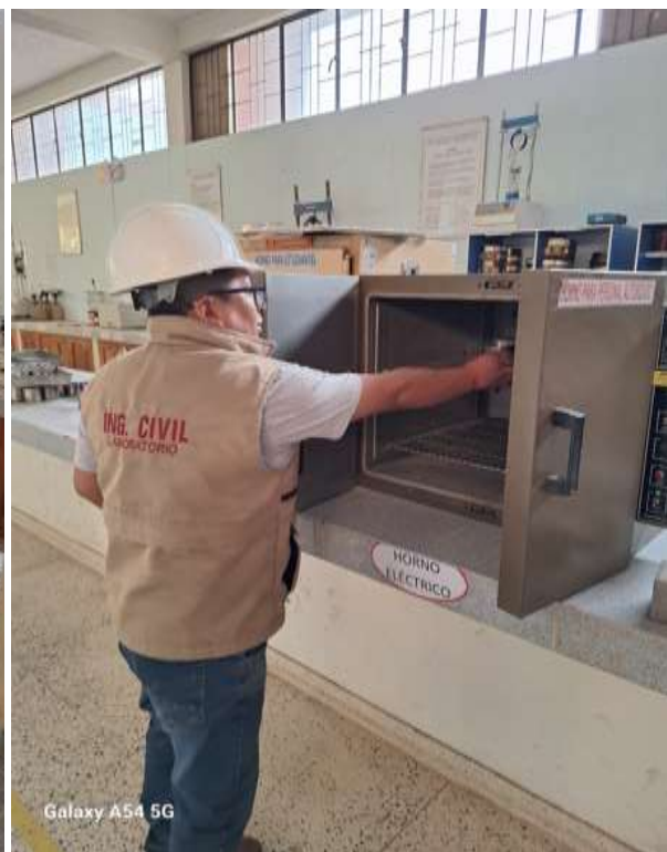
Fotografía 6. Ensayo en laboratorio- muestra secada en horno
