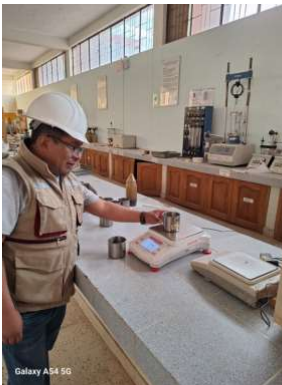
Fotografía 6. Ensayo en laboratorio- muestra secada en horno
