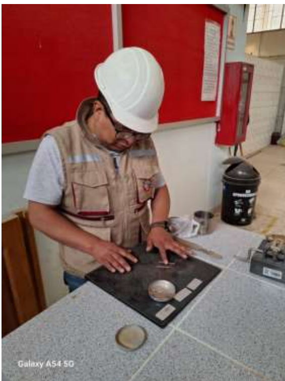
Fotografía 8. Ensayo en laboratorio-Limite plástico
