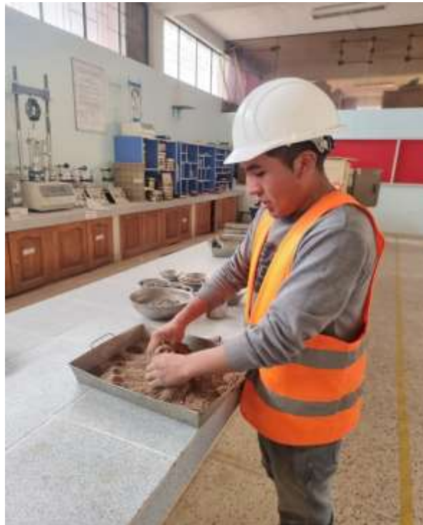
Fotografía 07. Realización de los análisis granulométricos
