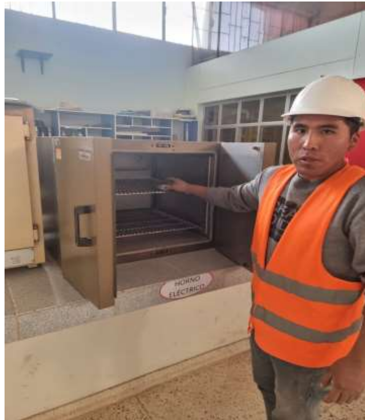
Fotografía 09. Secado de las muestras (contenidos de humedad)
