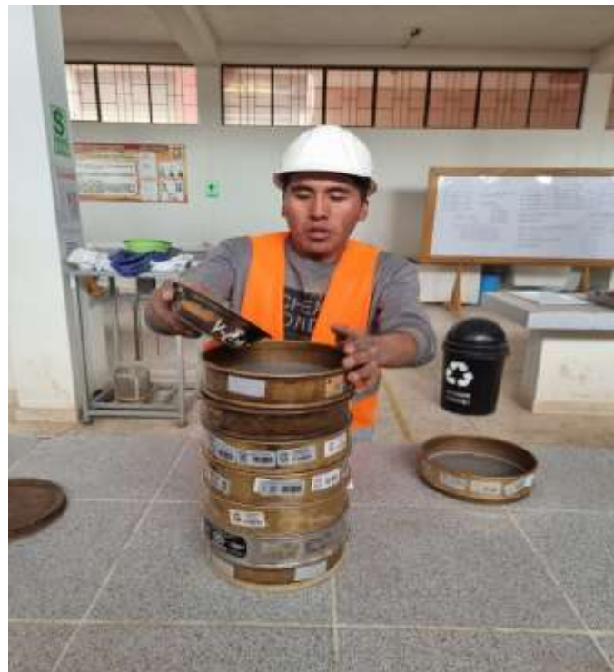
Fotografía 10. Tamizado de las muestras de la avenida Tintaya
