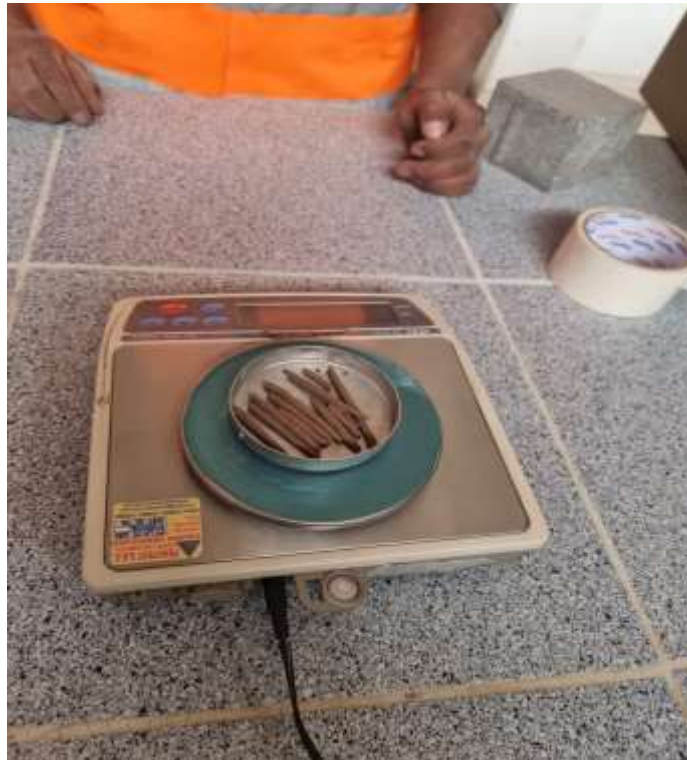
Fotografía 05. Pesaje de las muestras para los análisis de suelos
