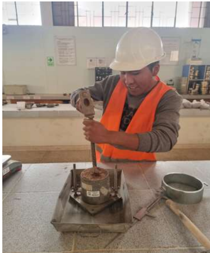
Fotografía 12. Realización del ensayo de compactación de suelos
