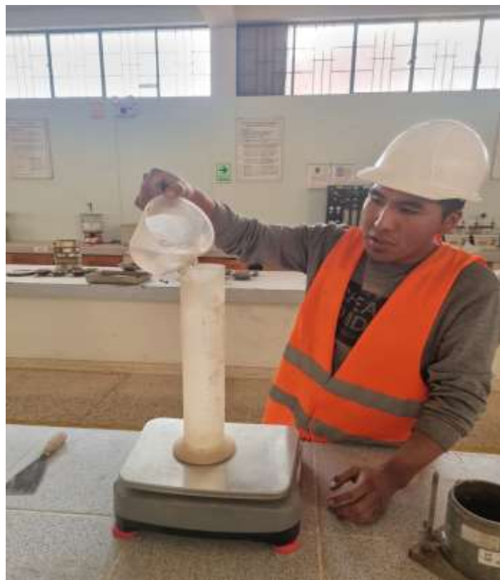
Fotografía 06. Pesaje de las pipetas para el cálculo de humedad
