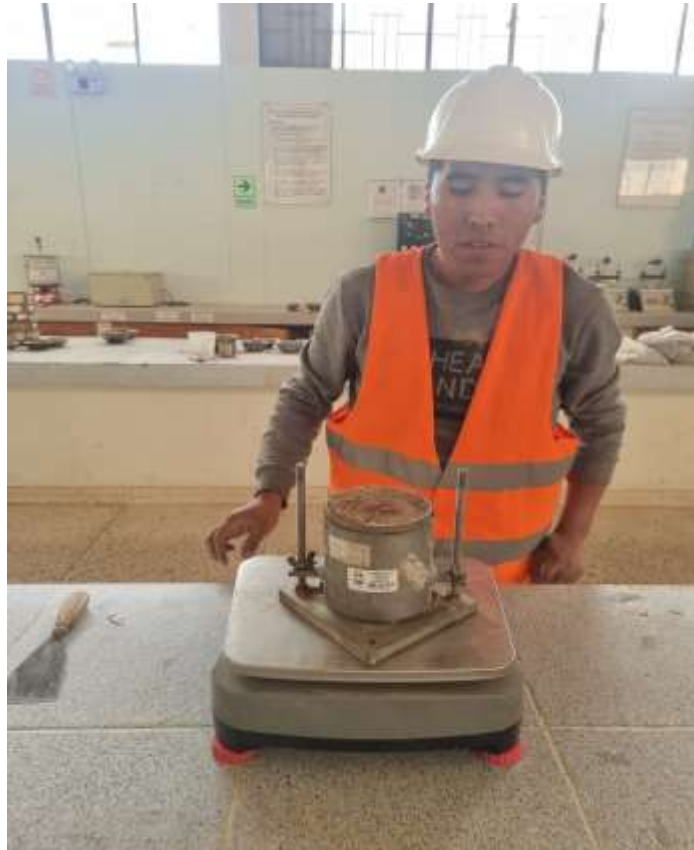
Fotografía 13. Pesado de las muestras a compactar
