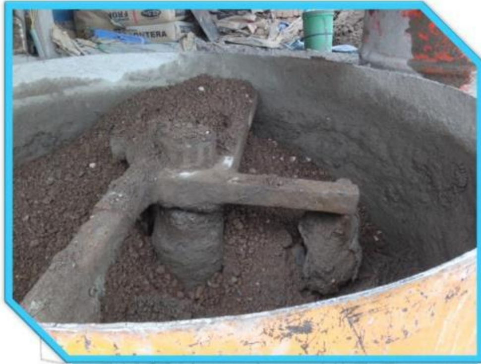
FOTOGRAFÍA 10: Mezcladora vertical del concreto utilizado para la fabricación de bloquetas de concreto.
