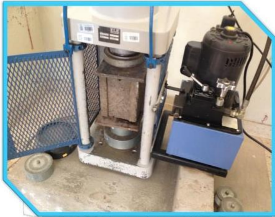
FOTOGRAFÍA 01: Verificación de resistencias a la compresión
