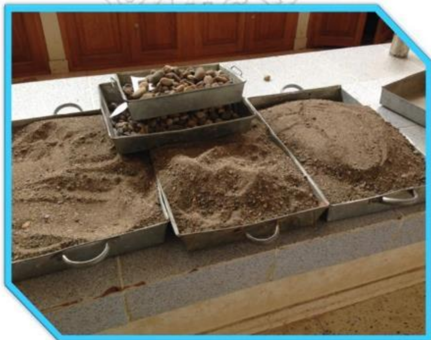
FOTOGRAFÍA 02: Dosificación de materiales para bloquetas
