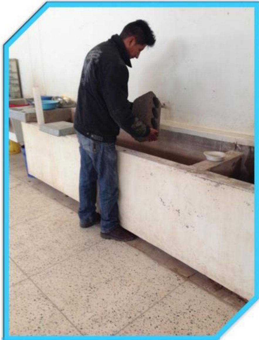
FOTOGRAFÍA 03: Curado de bloquetas mejoradas laboratorio CAPIC – UANCV.
