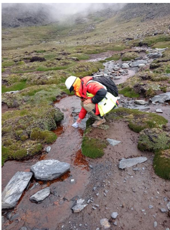
Fotografía 4. Toma de muestras para determinar la concentración del hierro en el agua superficial de la microcuenca Aricoma Limbani.
