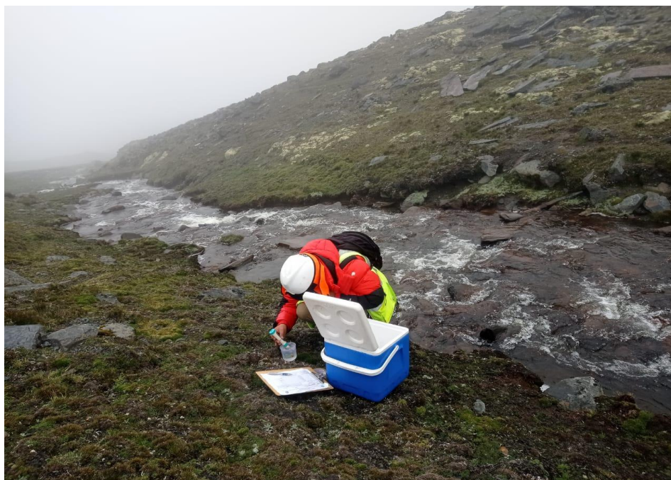
Fotografía 3. Evaluación del potencial de hidrogeno utilizando el equipo multiparámetro portátil.
