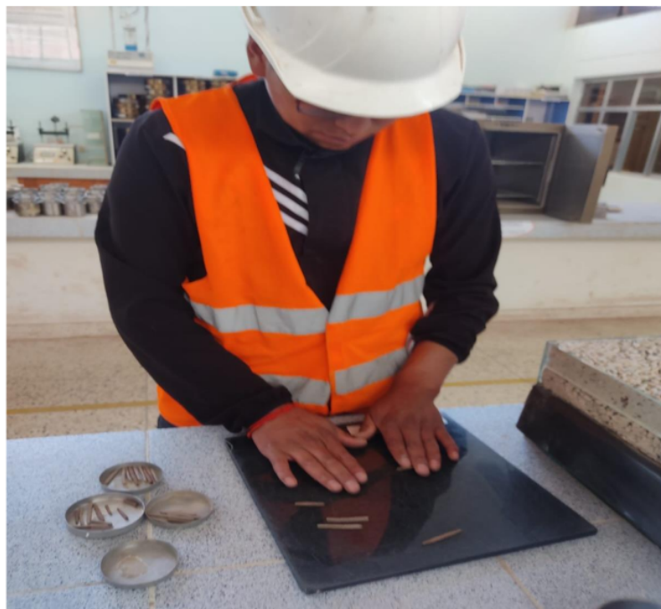
Fotografía 12. Ensayo de limite Plástico
