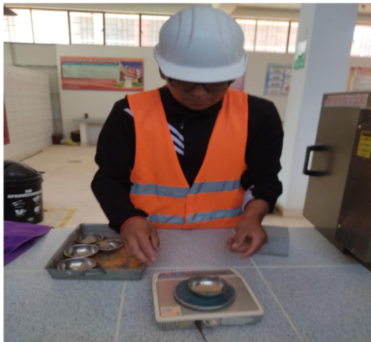
Fotografía 14. Pesaje de la muestra de límites paso 2
