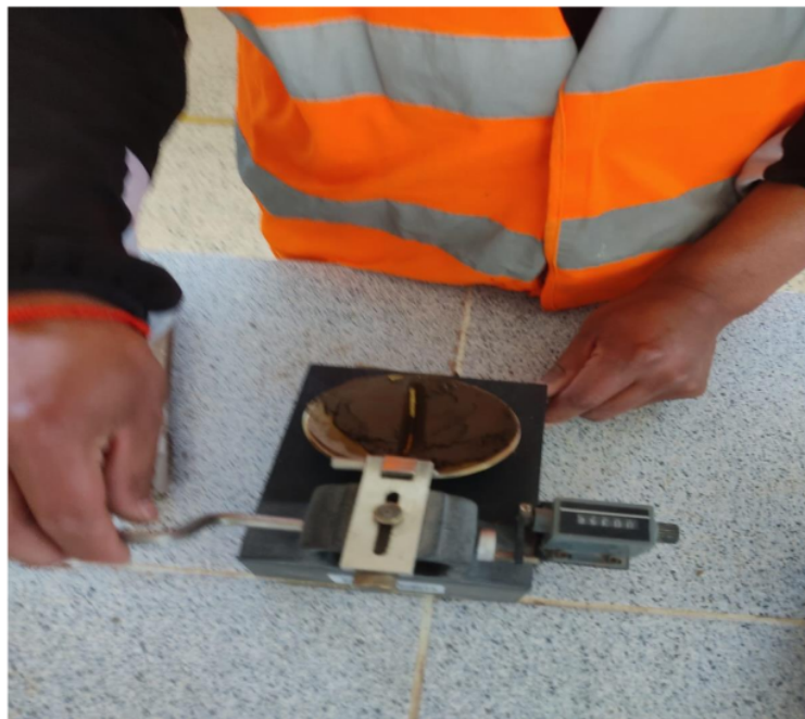
Fotografía 11. Ensayo de limite liquido paso 3
