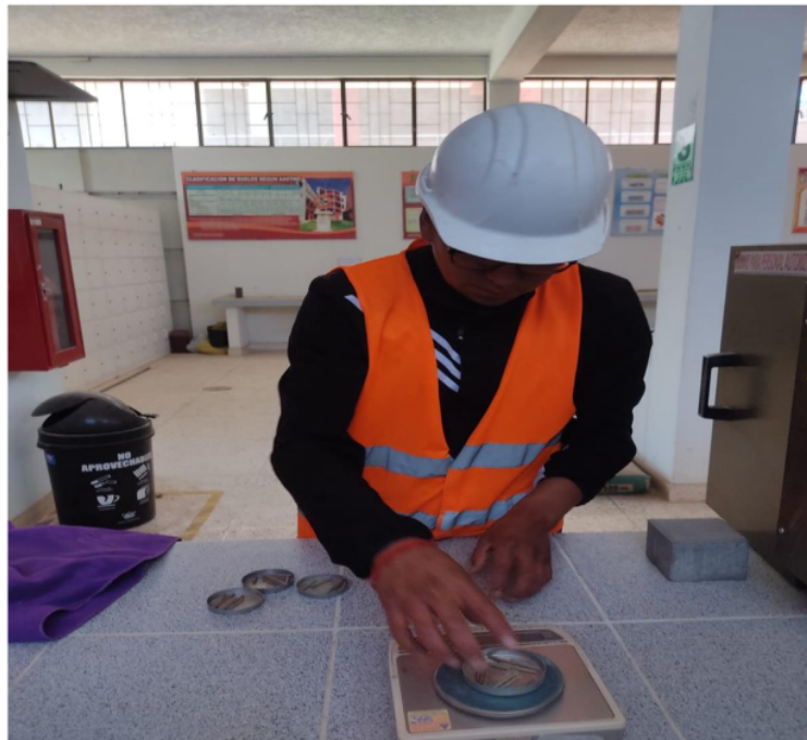
Fotografía 14. Pesaje de la muestra de límites paso 2
