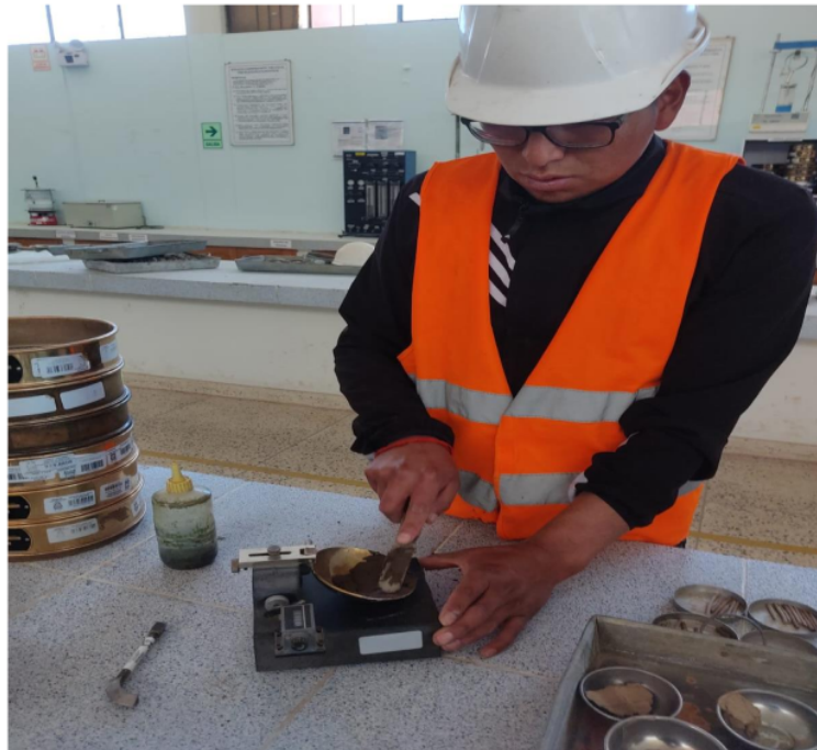
Fotografía 10. Ensayo de limite liquido paso 2
