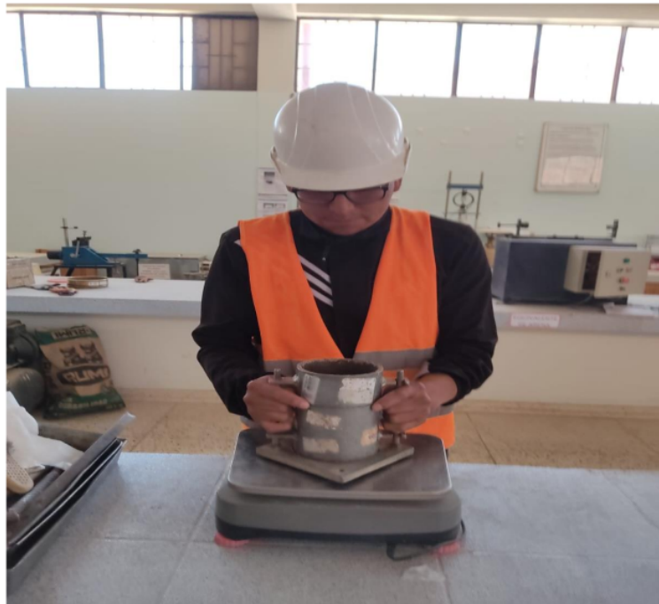
Fotografía 16. Pesaje del molde cilíndrico paso 1
