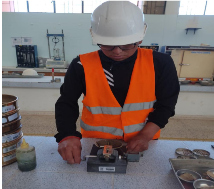
Fotografía 9. Ensayo de limite liquido paso 1
