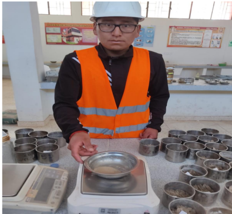
Fotografía 8. Pesaje de muestra para prueba de limites
