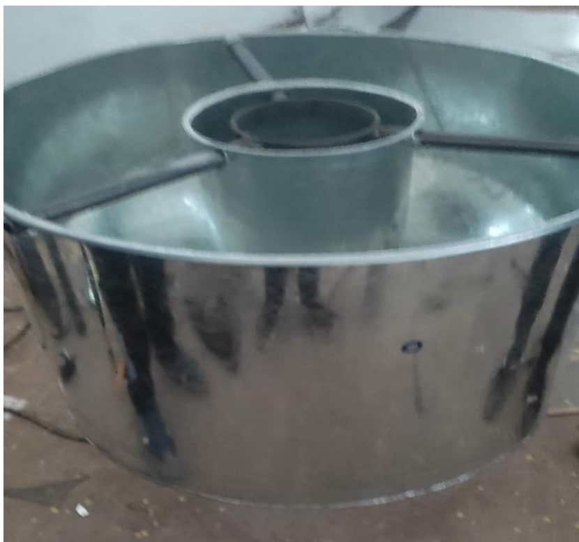
Fotografía 1. Etapa de construcción del reactor donde se muestra el material con el que se construye
