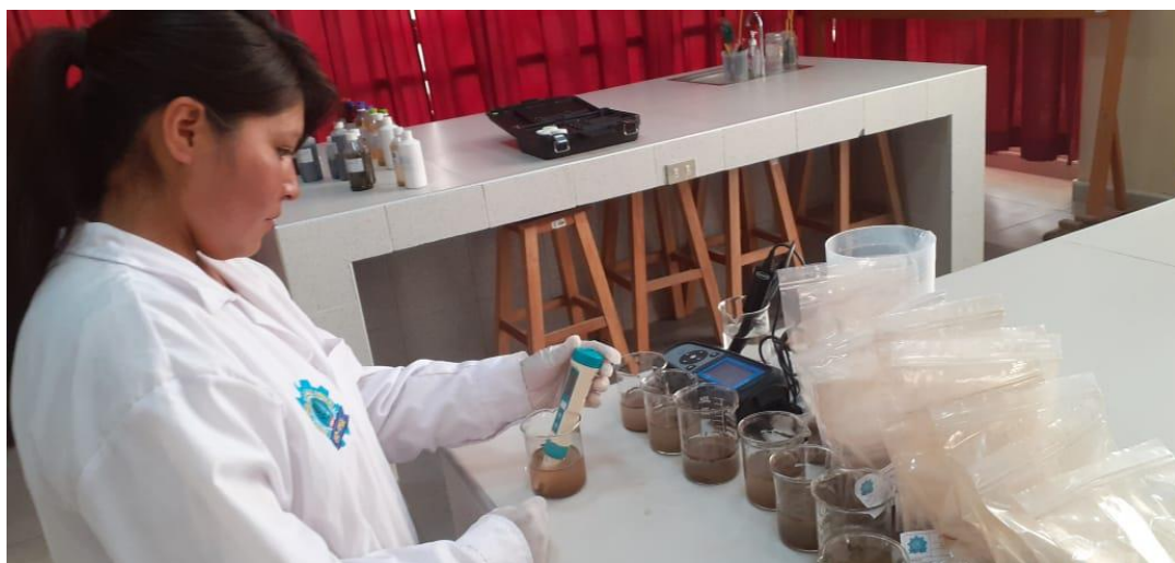
Nota. Monitoreo de la conductividad eléctrica de las muestras de suelo
