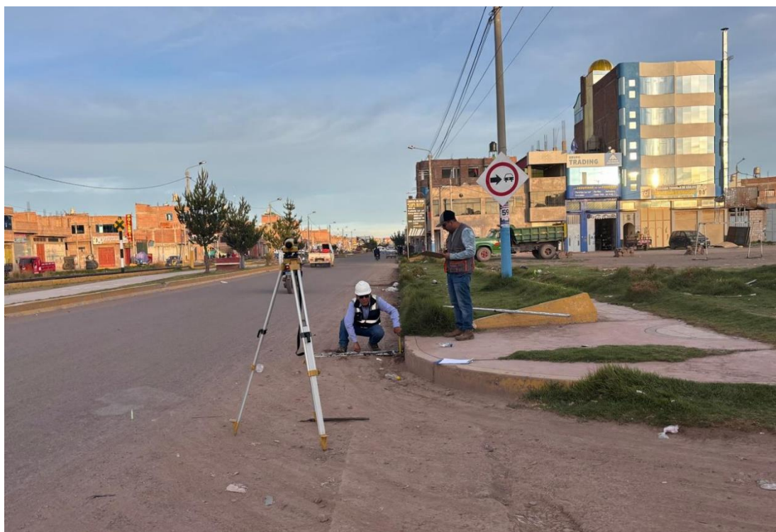
Fotografía 6.- Registro en campo de las dimensiones reales (ancho, tirante y geometría transversal) y evaluación del estado físico de conservación y mantenimiento de la cuneta.
