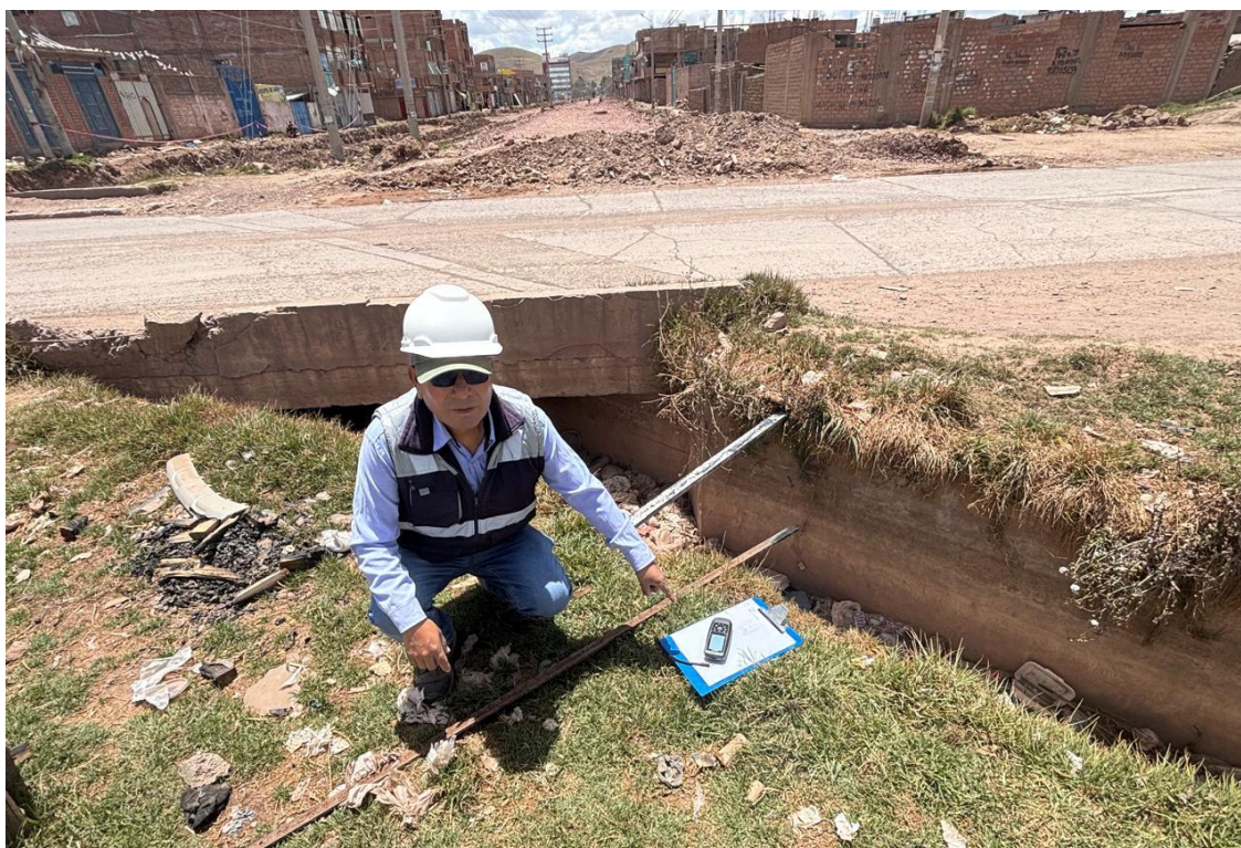
Fotografía 4.-Registro de la ubicación precisa de las alcantarillas mediante equipos GPS, para su correcta identificación y representación cartográfica.
