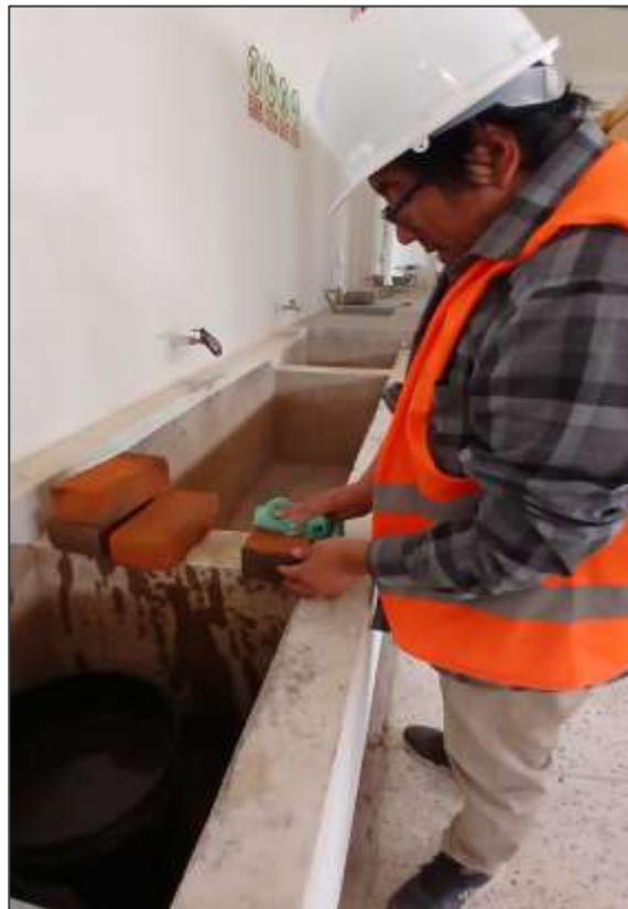
Fotografía N° 12: Secado o limpiado de muestras luego del ensayo de absorción
