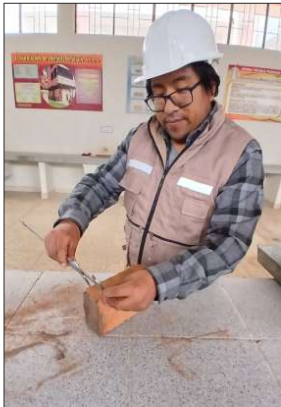
Fotografía N° 20: Variación dimensional del ladrillo realizado con vernier
