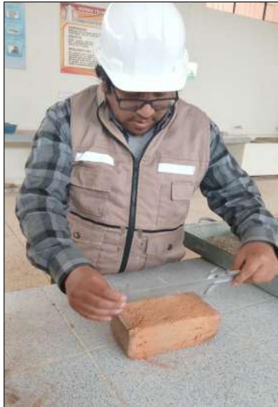
Fotografía N° 19: Medición de la variación dimensional del ladrillo
