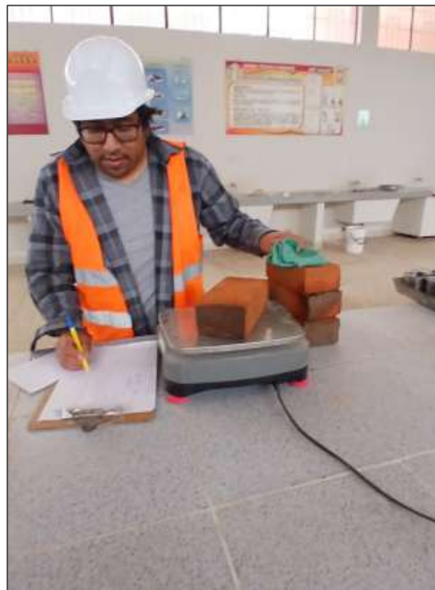
Fotografía N° 14: Pesado de las muestras luego de la absorción de agua
