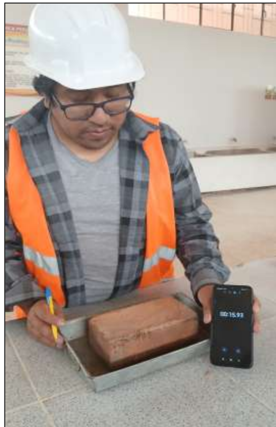
Fotografía N° 17: Calculo del tiempo en el ensayo de succión
