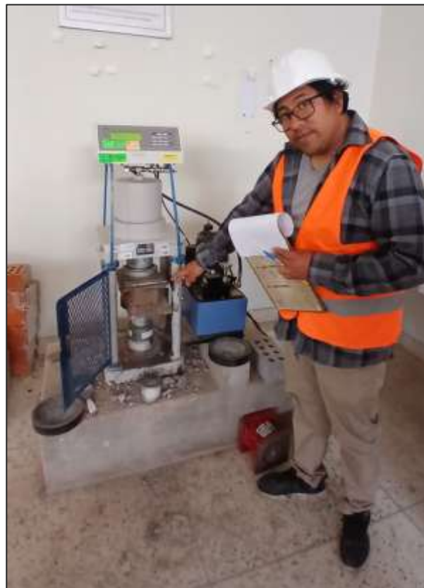
Fotografía N° 24: Prensa hidráulica para la resistencia a compresión
