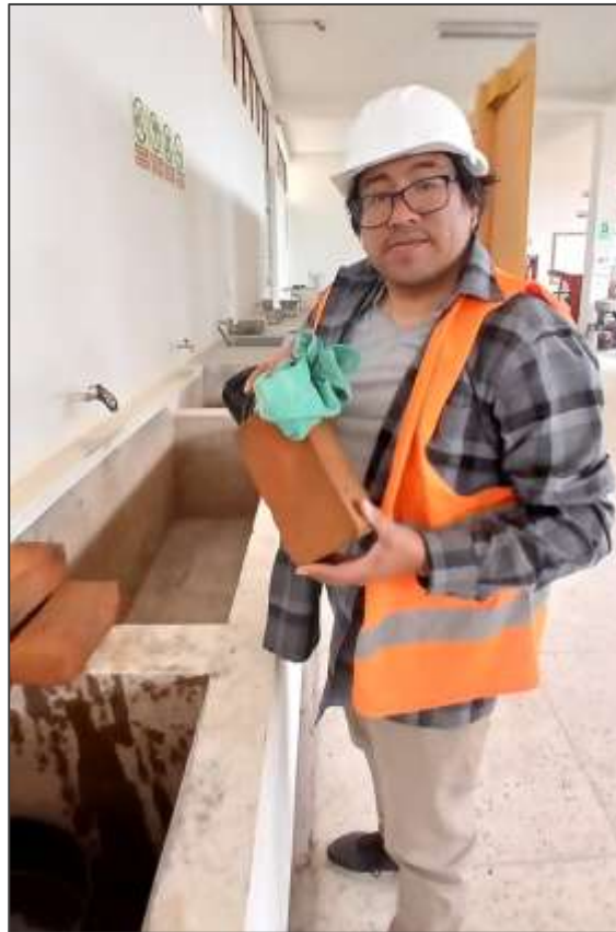
Fotografía N° 13: Secado o limpiado de muestras luego del ensayo de absorción
