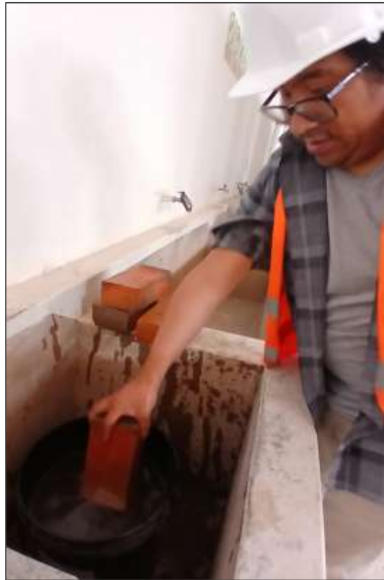
Fotografía N° 11: Retirado de muestras del ensayo de absorción
