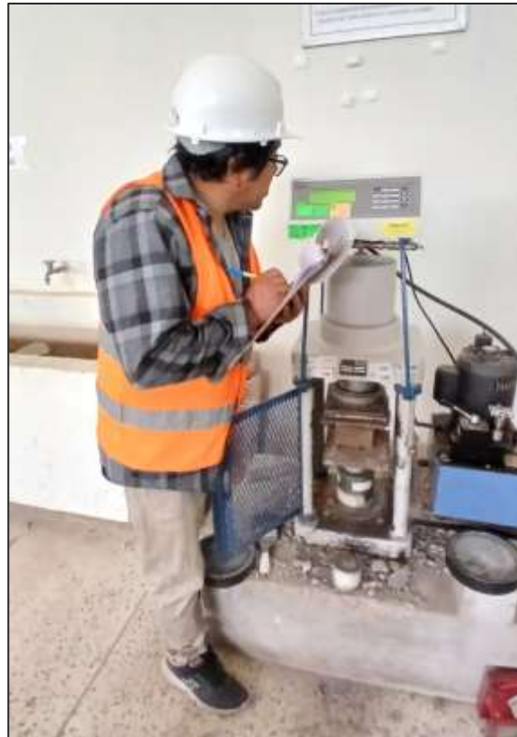
Fotografía N° 25: Ensayo de resistencia a la compresión
