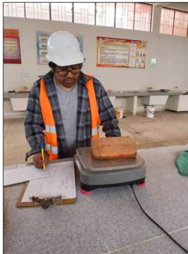
Fotografía N° 18: Pesado de las muestras luego del ensayo de succión
