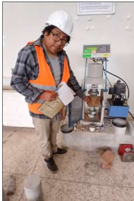
Fotografía N° 26: Rotura de la muestra en el ensayo de resistencia a la compresión
