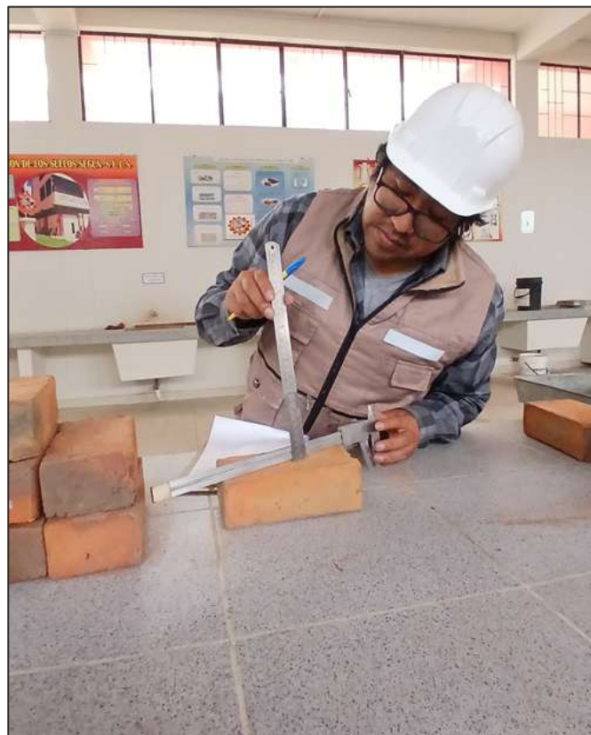
Fotografía N° 22: Ensayo de alabeo del ladrillo
