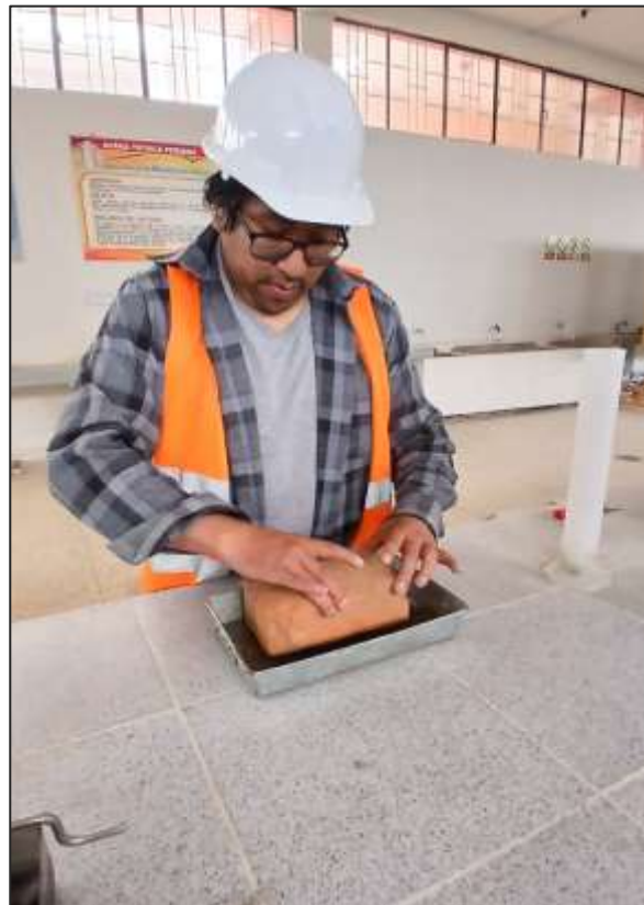
Fotografía N° 16: Ensayo de succión del ladrillo
