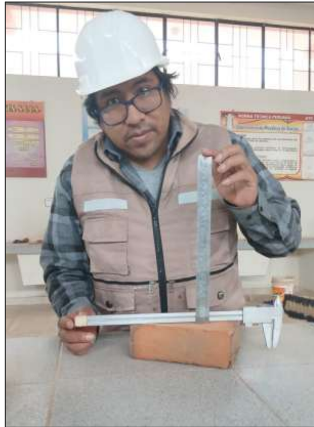
Fotografía N° 21: Medición del alabeo del ladrillo
