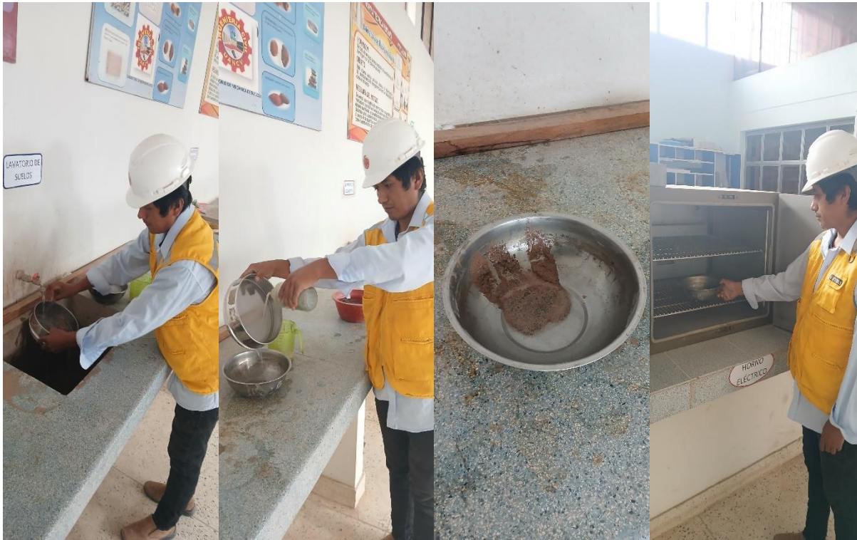
Figura 26. Ensayo de análisis granulométrico del en de la capacidad portante de cimentación la Urbanización Santo Tomas. E. Vilcapaza 2024
