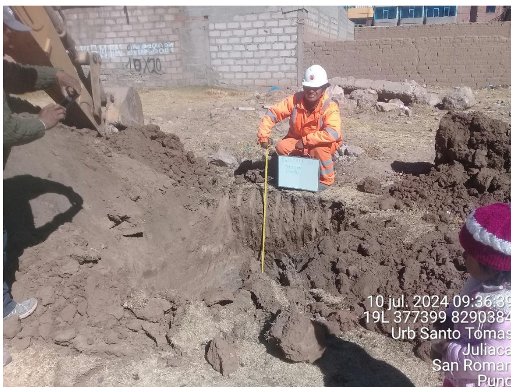
Figura 20. Extracción de muestras de muestra inalterada de la calicata 02. P. Palomino 2024
