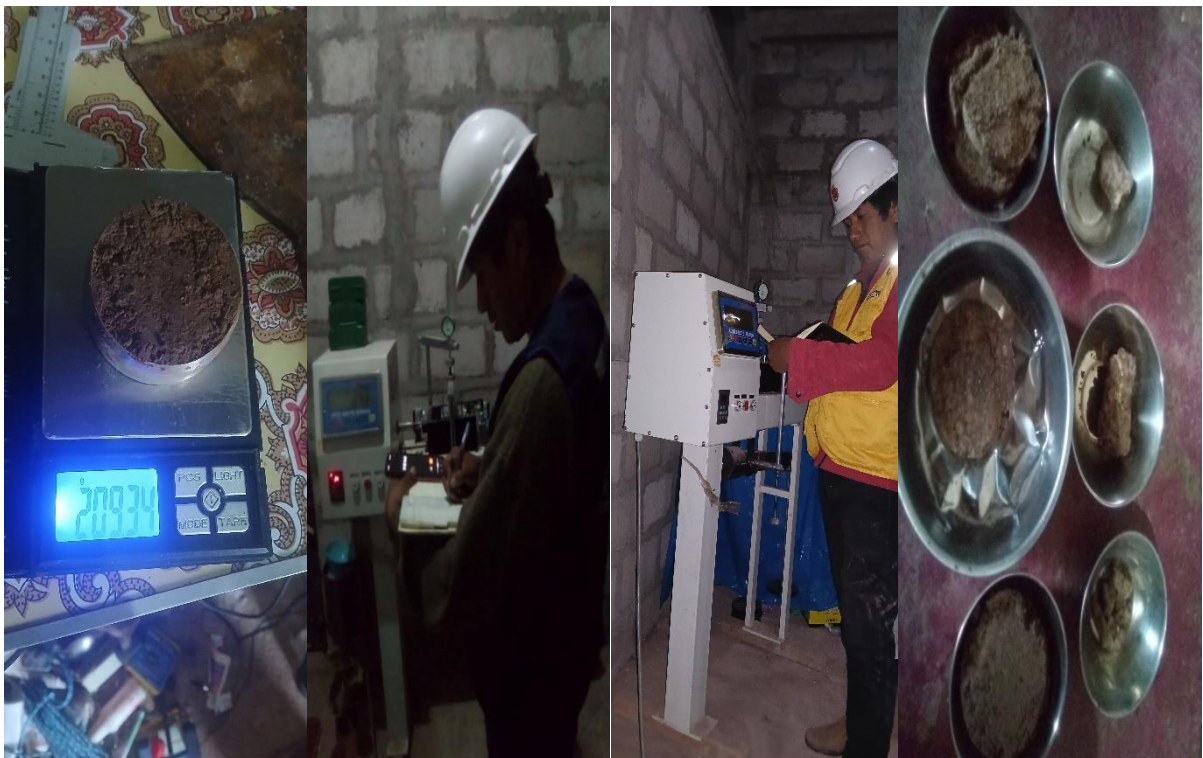
Figura 30. Ensayo de corte directo para cimentación en la Urbanización Santo Tomas. L. Condori 2024
