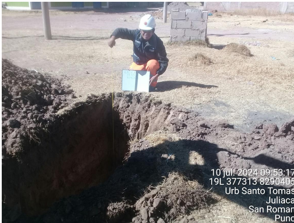
Figura 22. Extracción de muestras de muestra inalterada de la calicata 04. P. Palomino 2024
