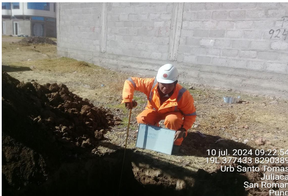
Figura 20. Extracción de muestras de muestra inalterada de la calicata 02. P. Palomino 2024
