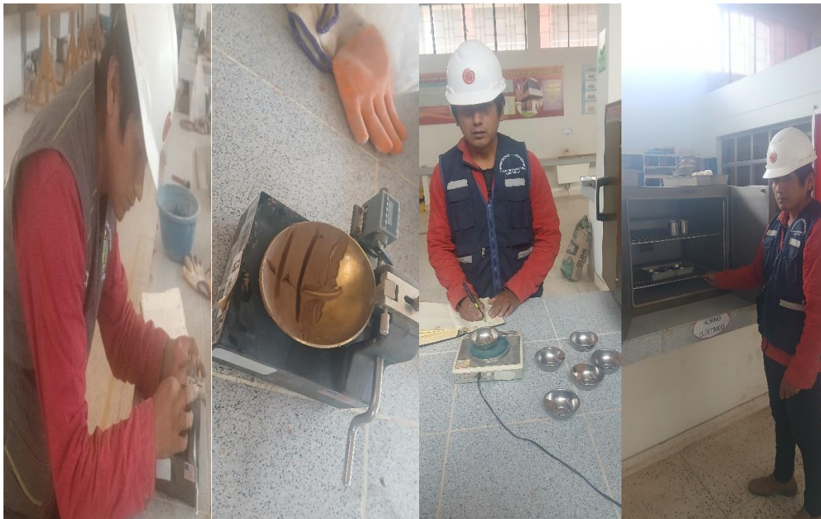
Figura 28. Ensayo de limite liquido de la Urbanización Santo Tomas. E. Vilcapaza 2024
