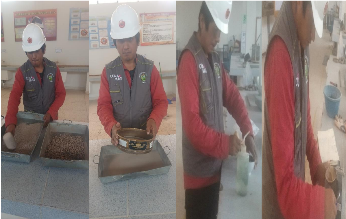
Figura 28. Ensayo de limite liquido de la Urbanización Santo Tomas. E. Vilcapaza 2024
