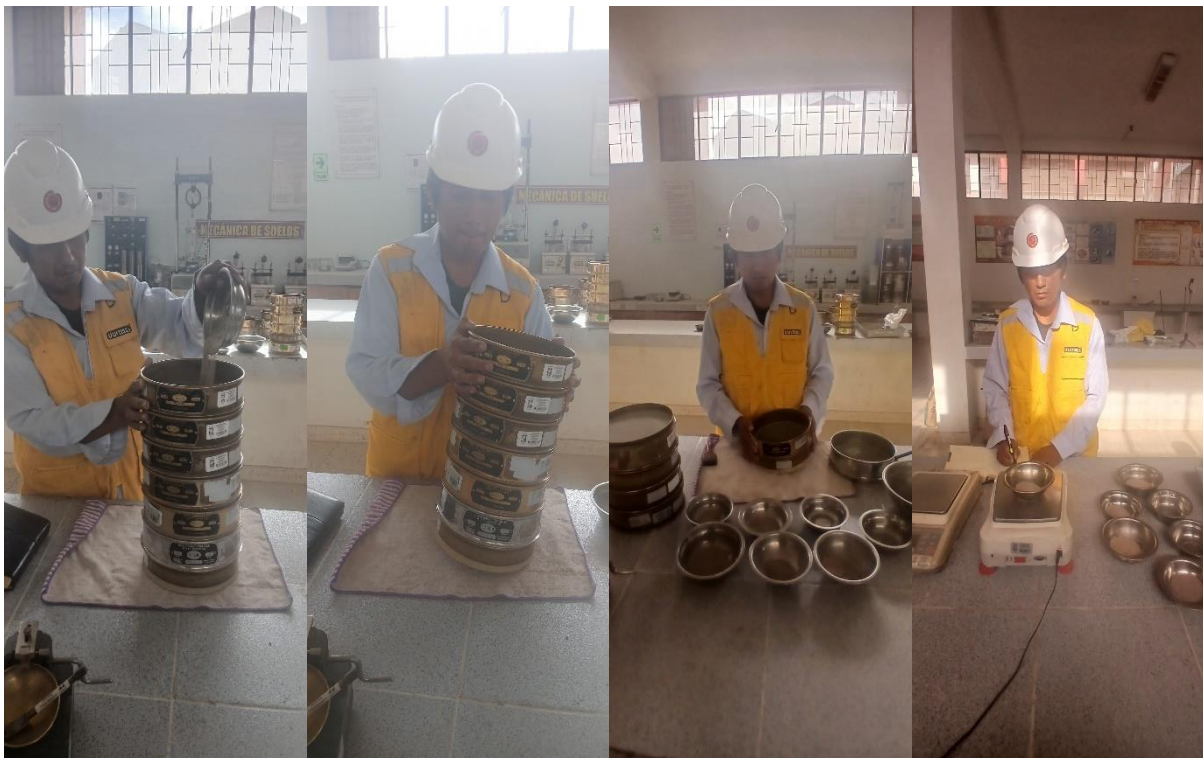
Figura 26. Ensayo de análisis granulométrico del en de la capacidad portante de cimentación la Urbanización Santo Tomas. E. Vilcapaza 2024
