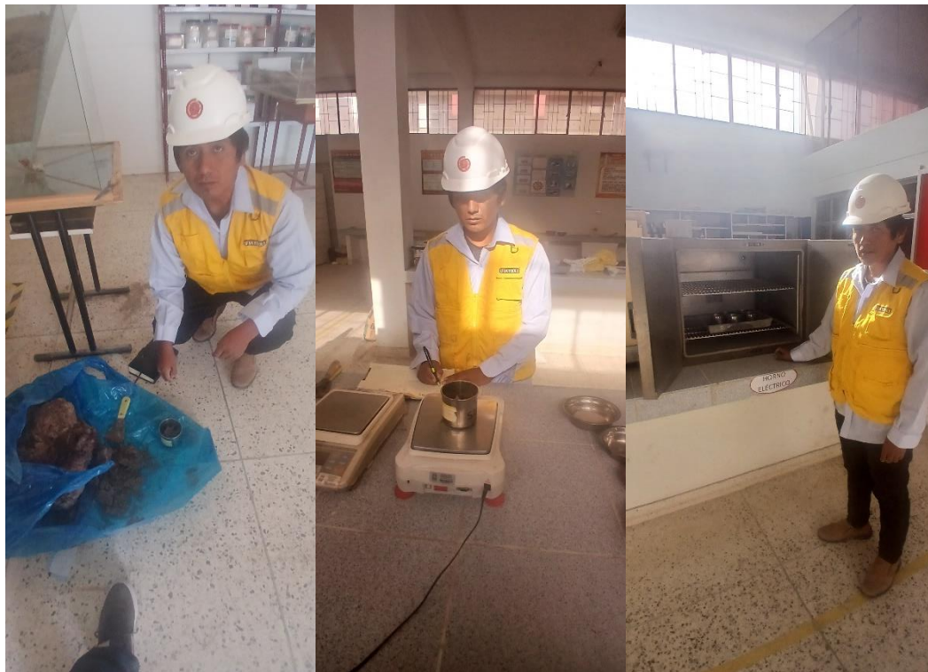
Figura 24. Ensayo de contenido de humedad de la capacidad portante de cimentación inalterado de la Urbanización Santo Tomas. E. Vilcapaza 2024
