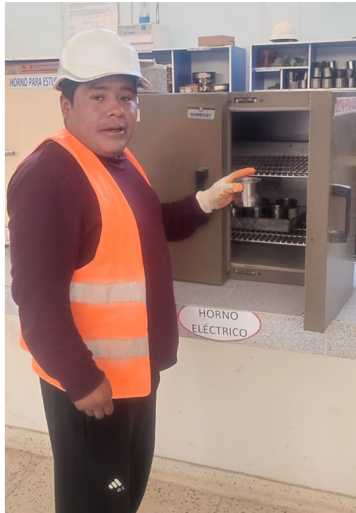
Fotografía 1. Prueba de contenido de humedad.
