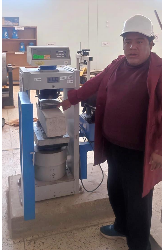
Fotografía 15. Rotura de viguetas.
