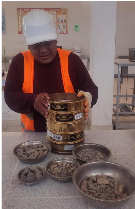
Fotografía 4. Tamizado de agregados gruesos.
