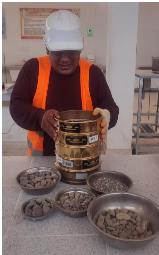
Fotografía 2. Tamizado de agregados.
