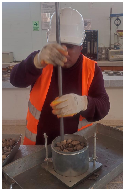
Fotografía 6. Prueba de pesos unitarios varillados en agregados.
