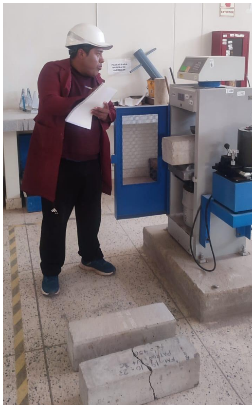
Fotografía 16. Control de valores de rotura de viguetas.
