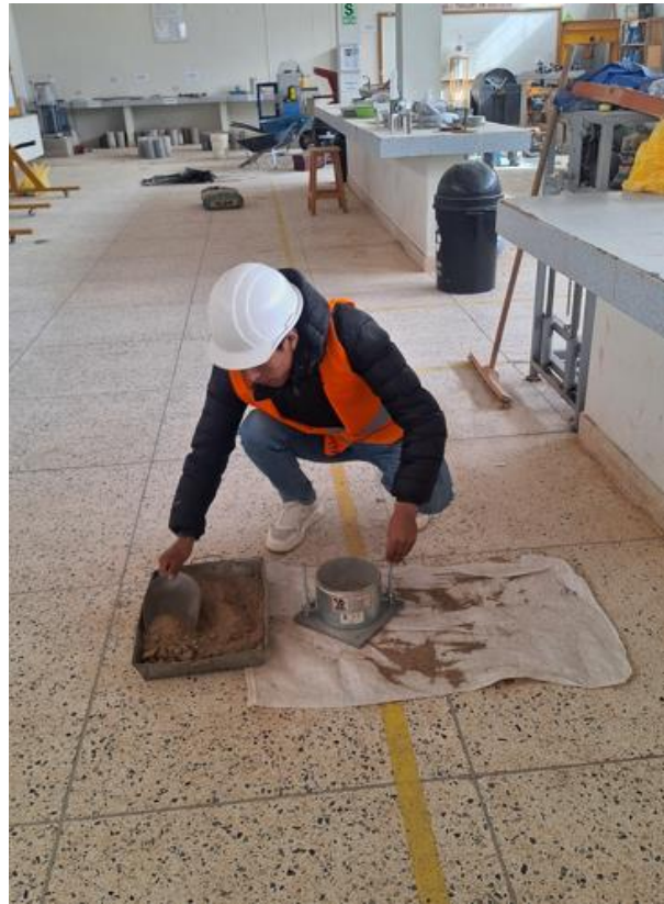
Fotografía N° 12: Apisonado de muestra en capas en el molde
