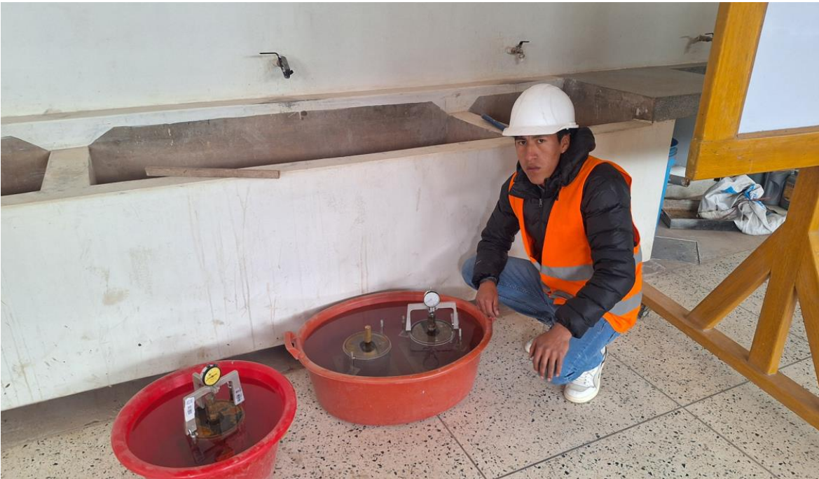
Fotografía Nº 16: Medición de la expansión a cada 30 min.
