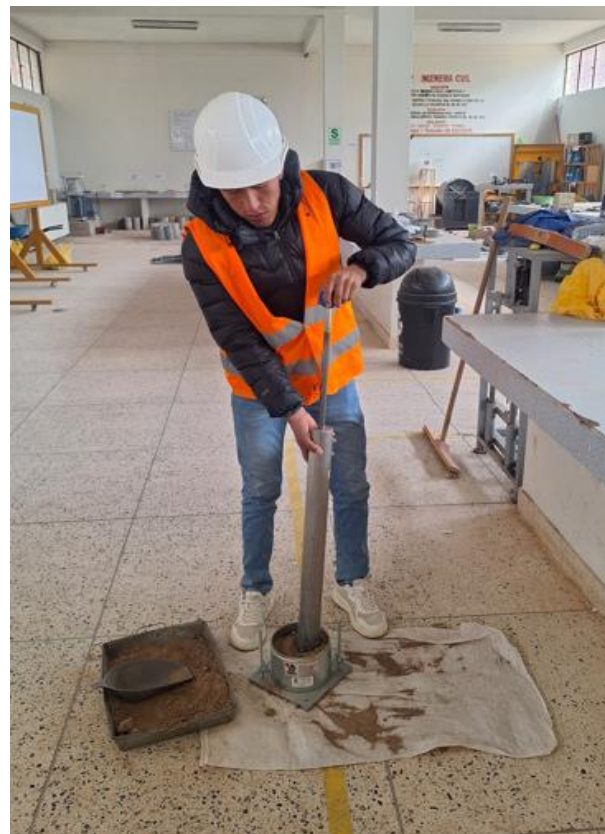
Fotografía N° 12: Apisonado de muestra en capas en el molde
