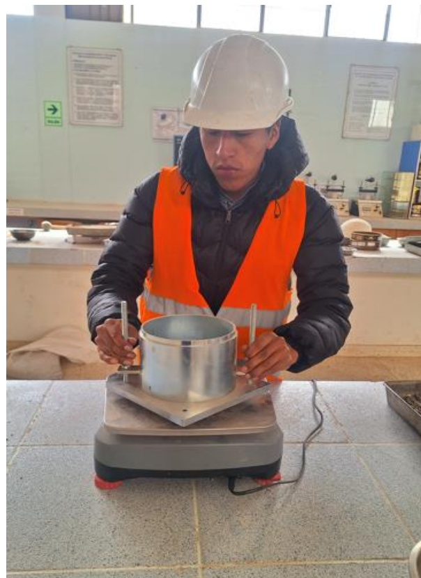
Fotografía N° 10: Pesado de molde de Proctor modificado
