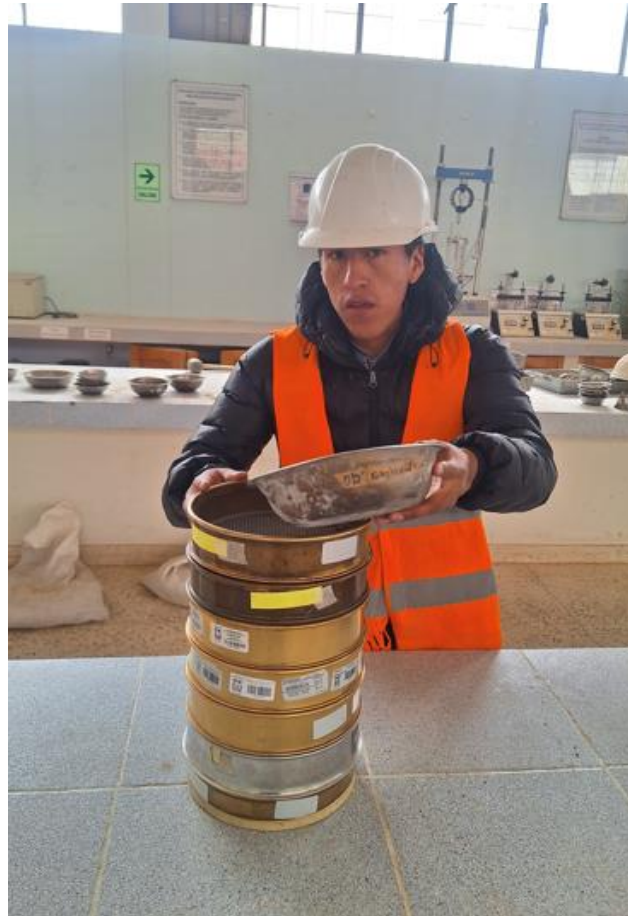
Fotografía N° 01: Colocado de muestra para tamizado
