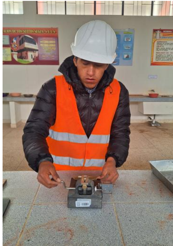
Fotografía N° 09: Manipulación del equipo de cuchara de Casagrande
