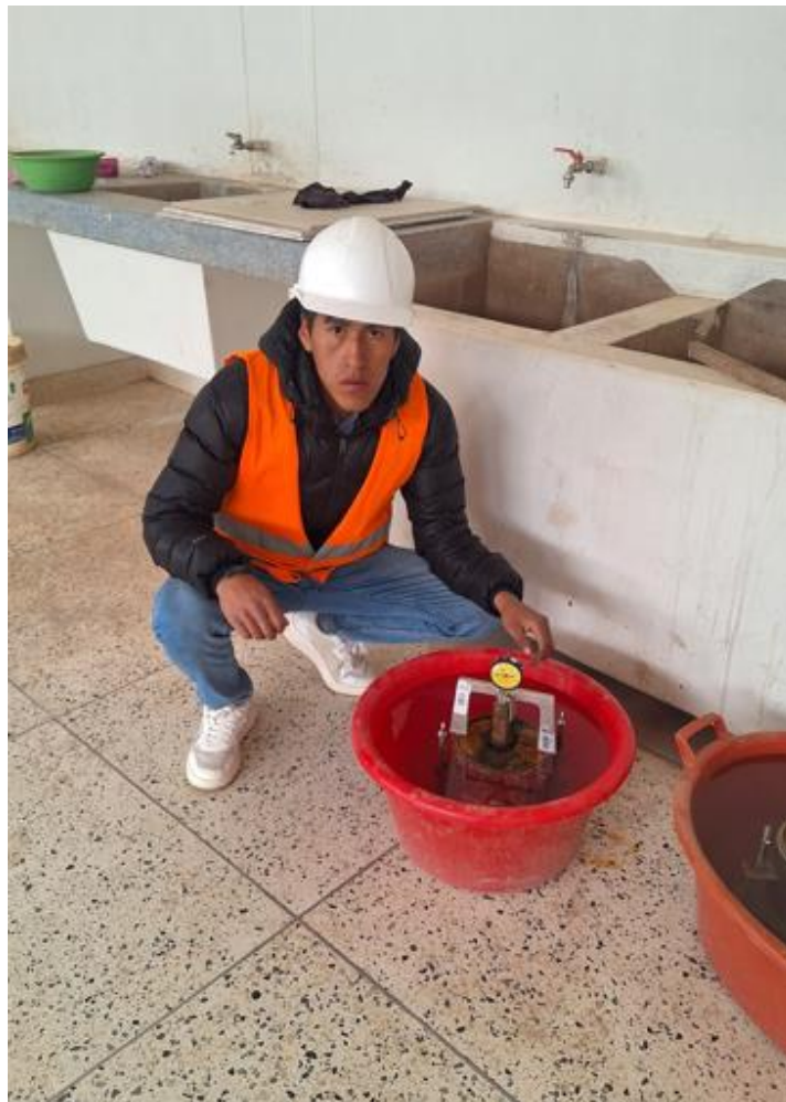
Fotografía Nº 16: Medición de la expansión a cada 30 min.
