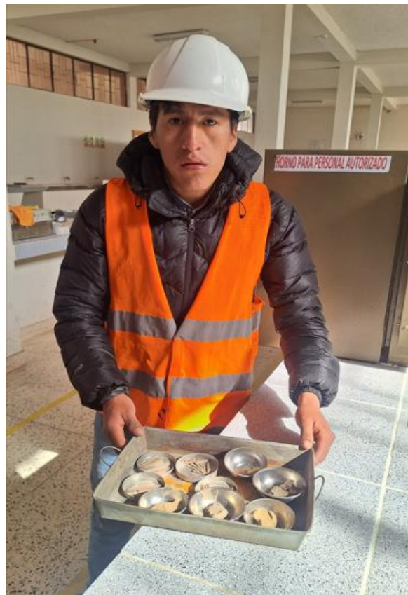
Fotografía N° 06: Clasificación de muestras de límite líquido y plástico
