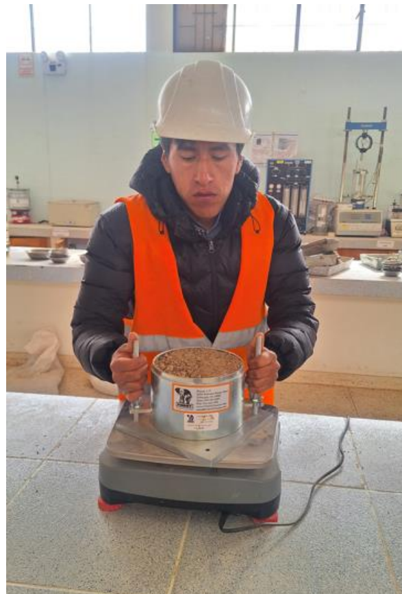
Fotografía N° 14: Pesado de la muestra compactada + molde
