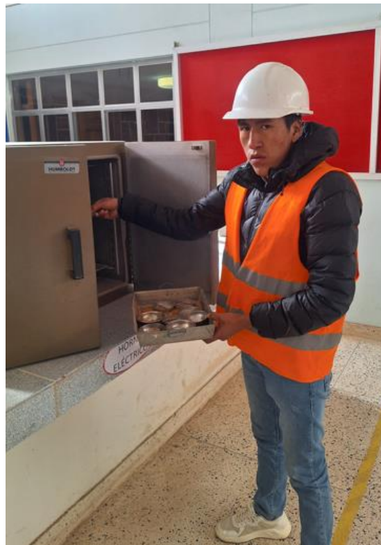
Fotografía N° 18: Colocado de muestras en el horno para conocer el contenido de humedad
