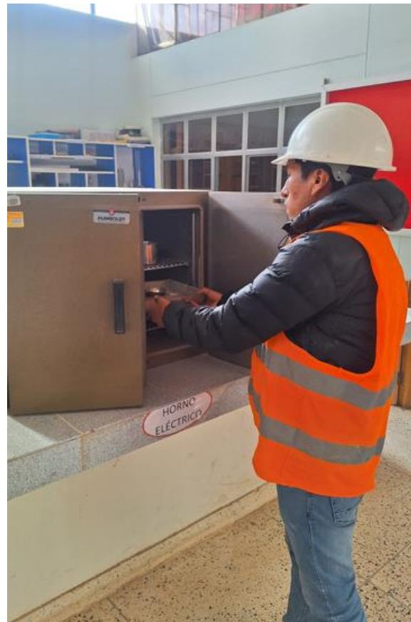
Fotografía N° 20: Retirado de muestras del horno
