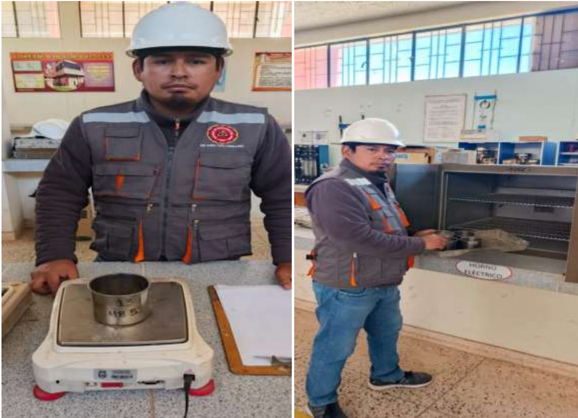
Fotografía 1. Humedad del material
