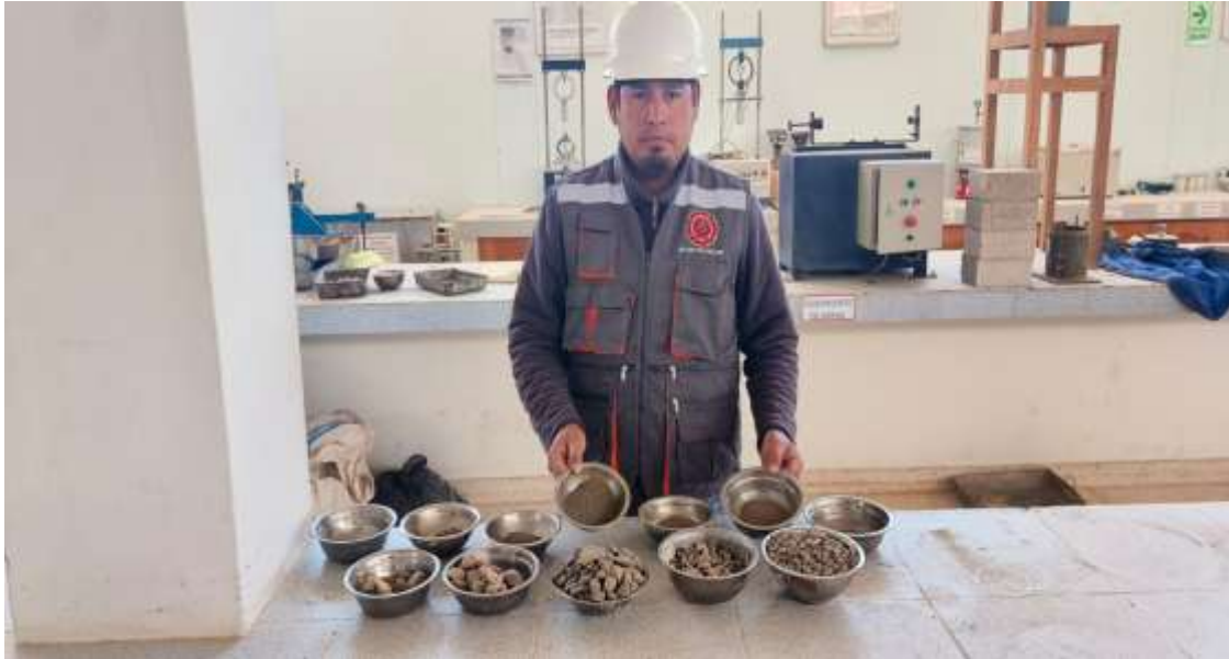
Fotografía 3. Análisis de distribución granulométrica
