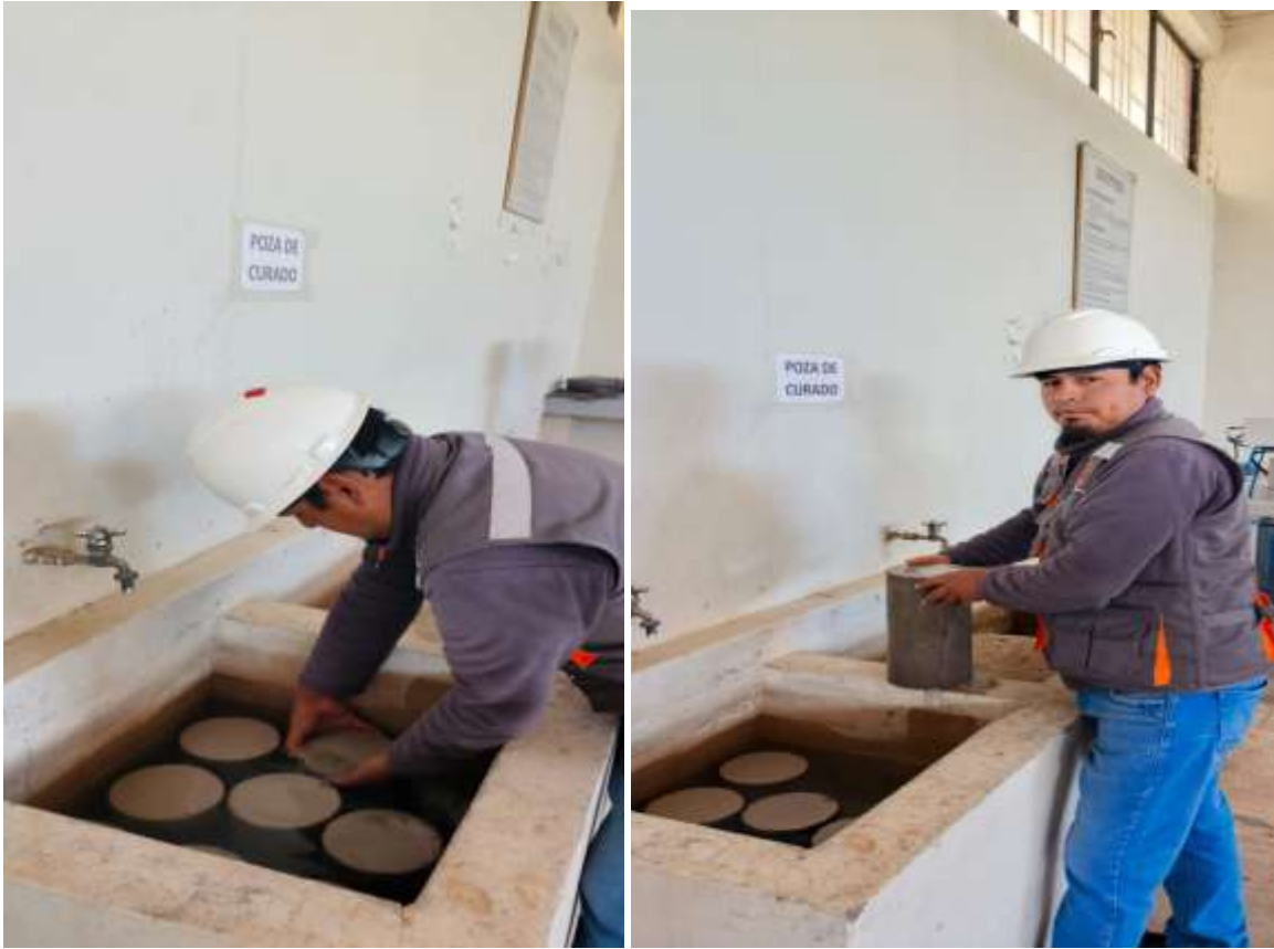
Fotografía 5. Curado de las briquetas
