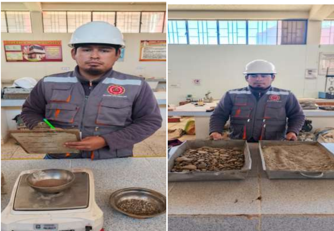
Fotografía 2. Análisis de distribución granulométrica
