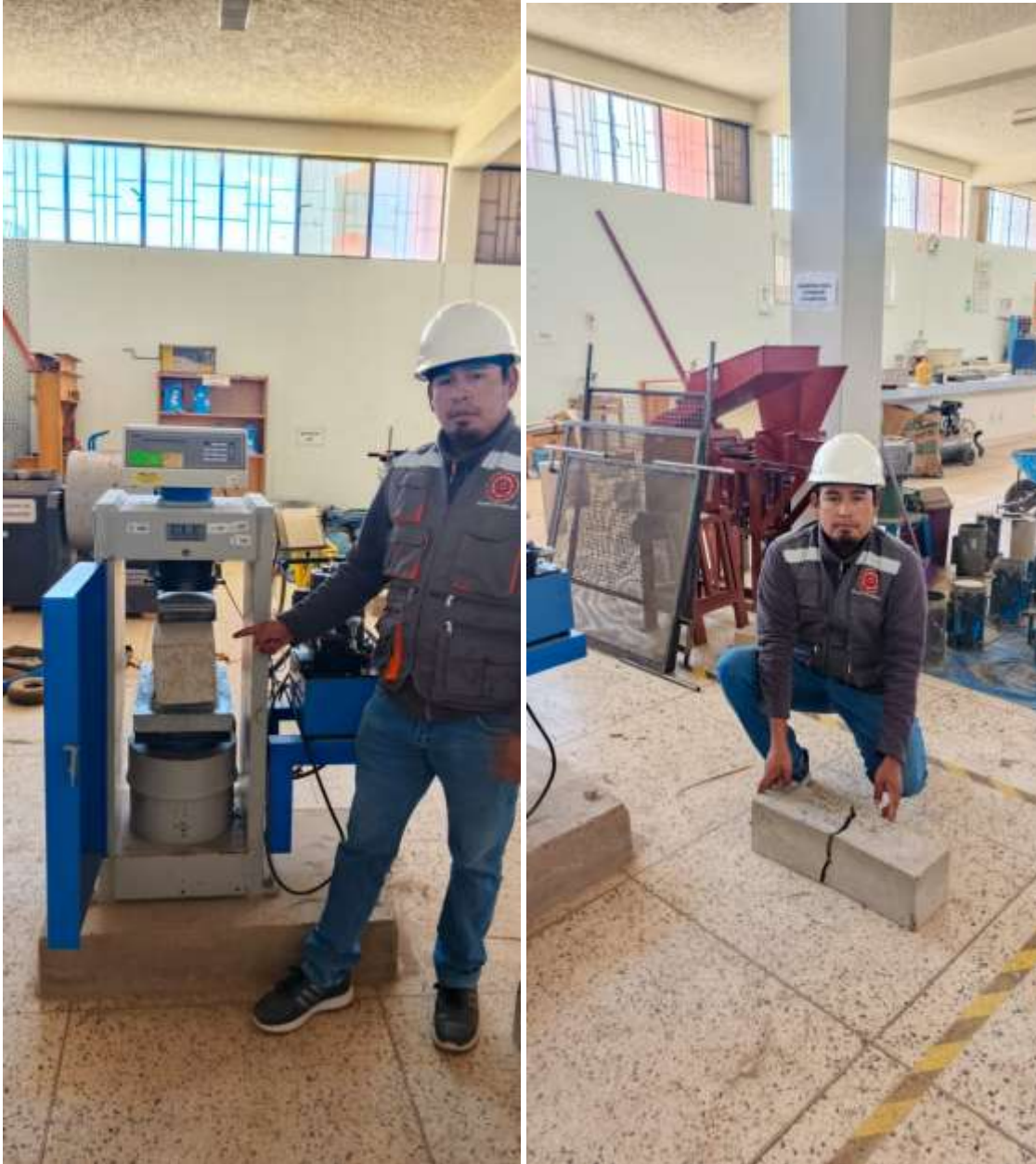
Fotografía 7. Rotura de briquetas de las vigas
