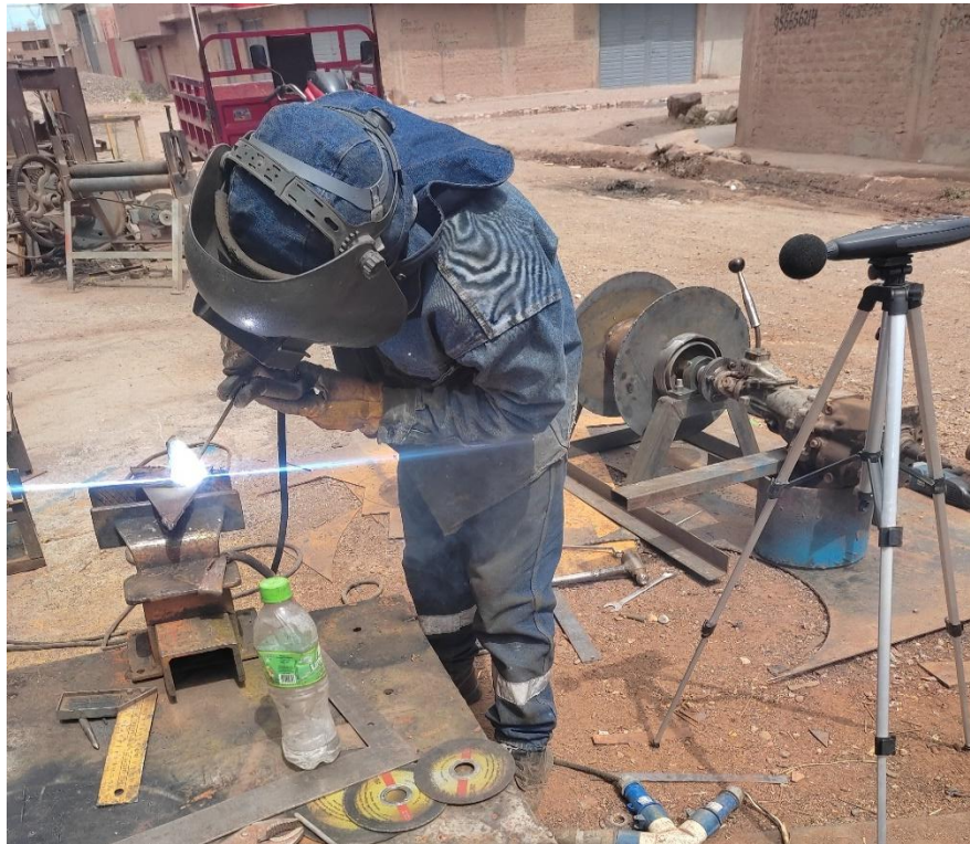
Figura 30 Medición en el área de soldadura
