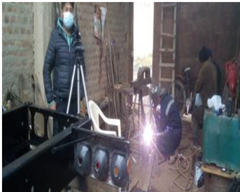
Figura 19: Imagen que representa a la medición de ruido en el área de soldadura dentro del taller
