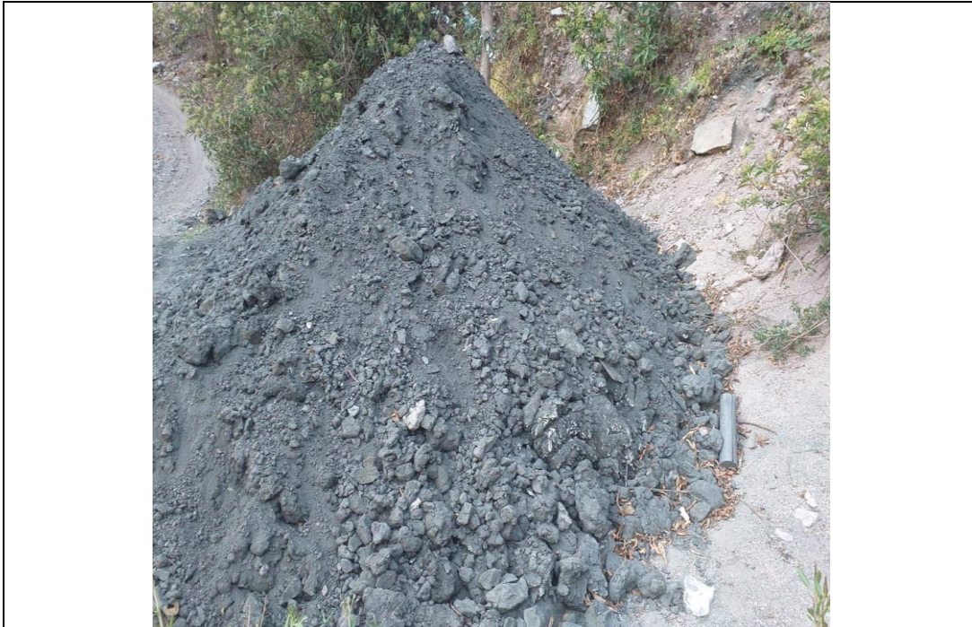
Fotografía N° 02: Almacenamiento de Lodo Deshidratado a la intemperie sin ningún tipo de tratamiento o señalización.
