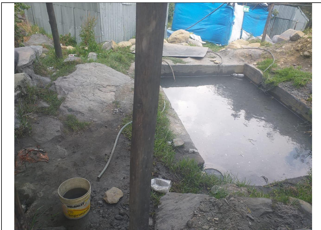
Fotografía N° 01: Almacenamiento de lodo hidratado con presencia de metales pesados, posterior a la molienda.
