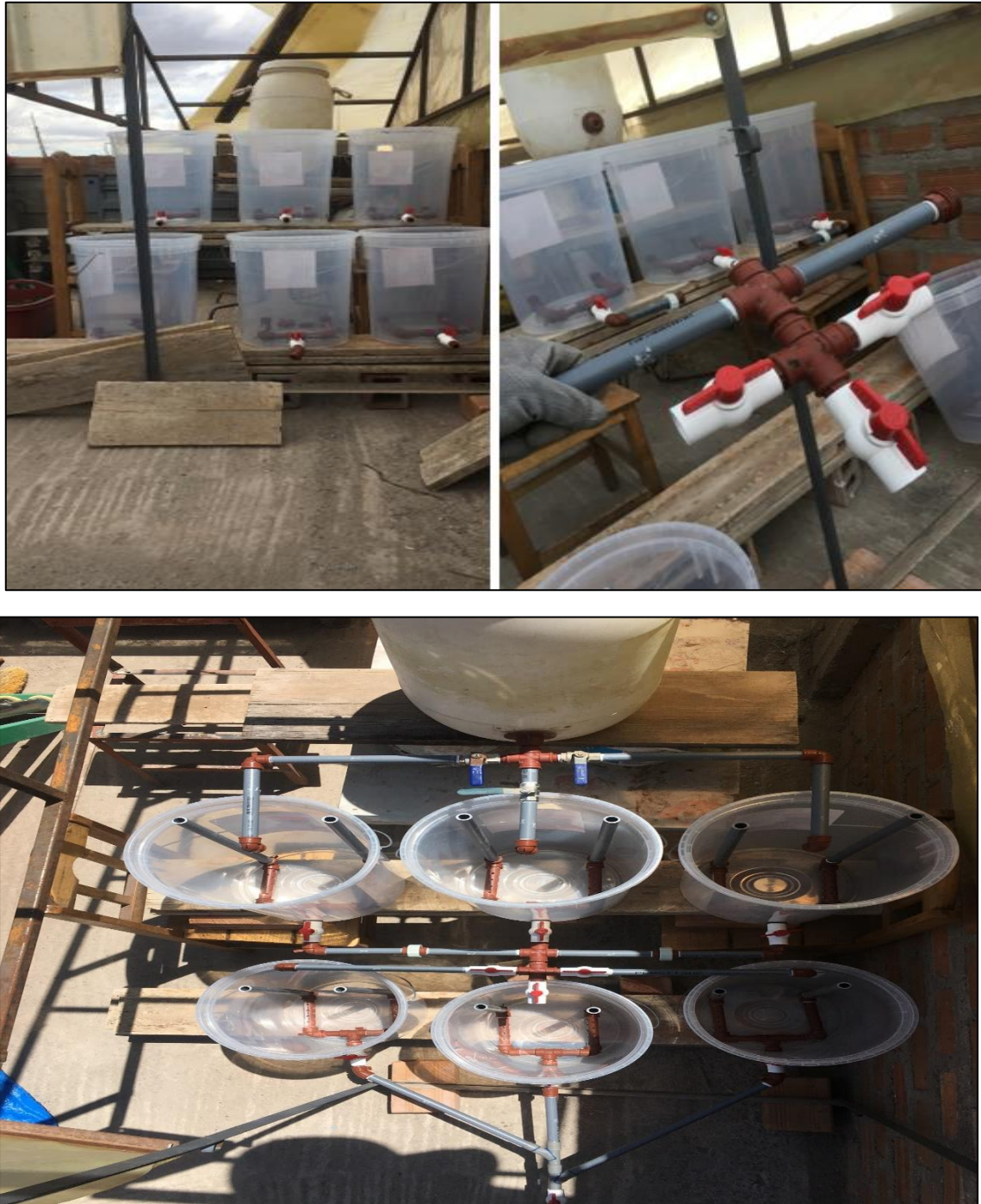
Construcción de humedal francés
