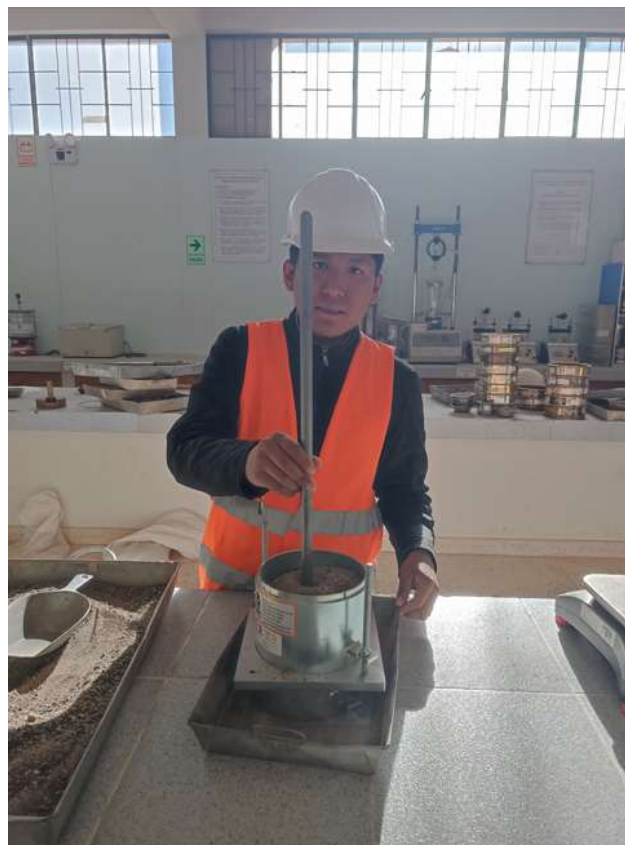
Fotografía N° 15: Enrasado de muestra para peso unitario
