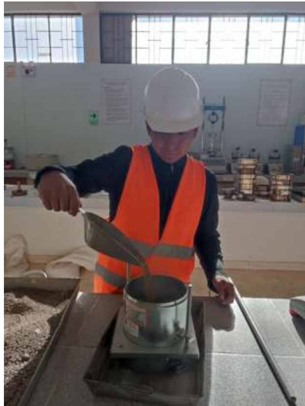
Fotografía N° 14: Varillado de muestra para peso unitario
