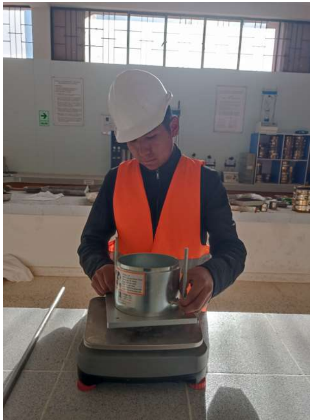
Fotografía N° 13: Llenado de la muestra seca para peso unitario
