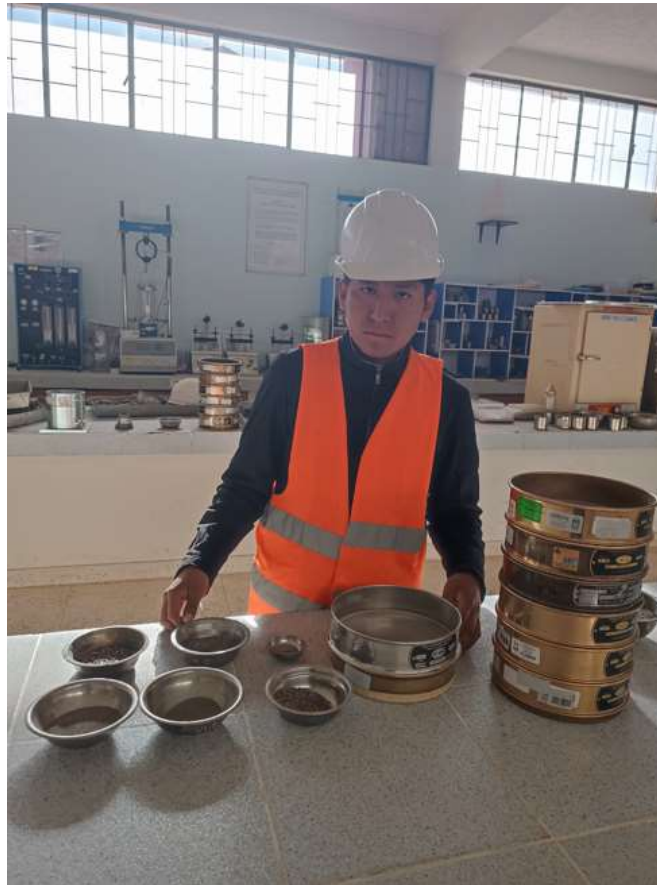
Fotografía N° 01: Ensayo de análisis granulométrico
