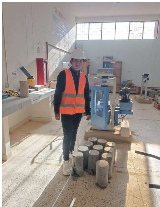
Fotografía N° 11: Rotura de la briqueta
