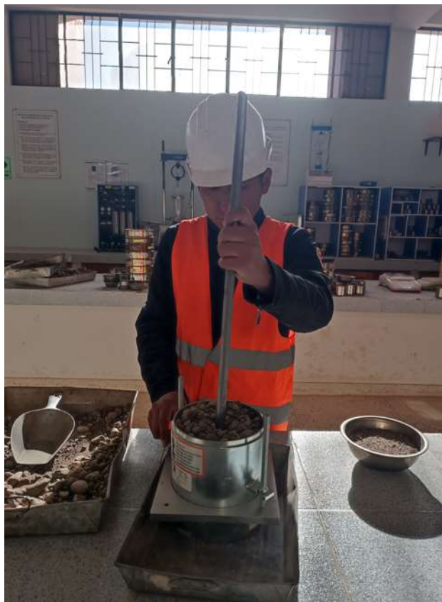
Fotografía N° 19: Enrasado del agrado grueso para peso unitario
