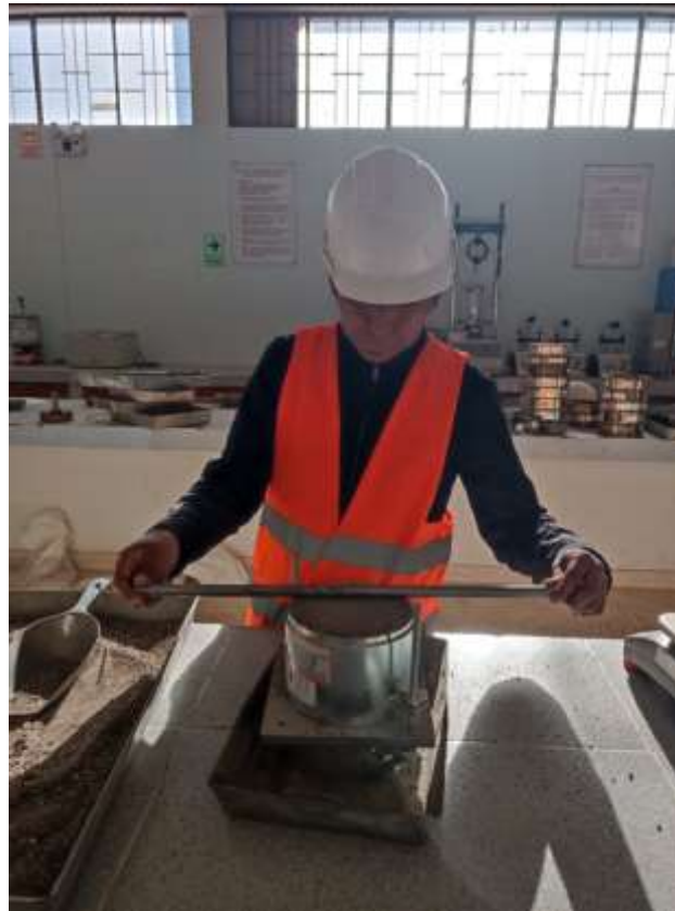
Fotografía N° 16: Pesado de molde más muestra para peso unitario
