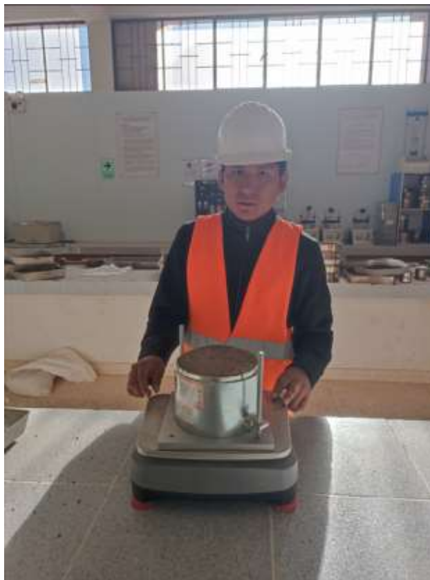
Fotografía N° 17: Llenado de agregado grueso para peso unitario
