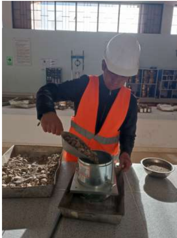
Fotografía N° 18: Varillado del agregado grueso para peso unitario
