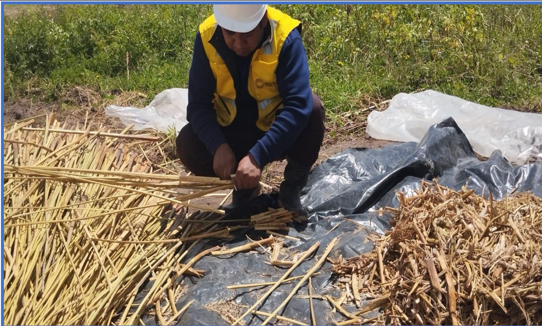
Fotografía 4. Preparación de la fibra de totora
