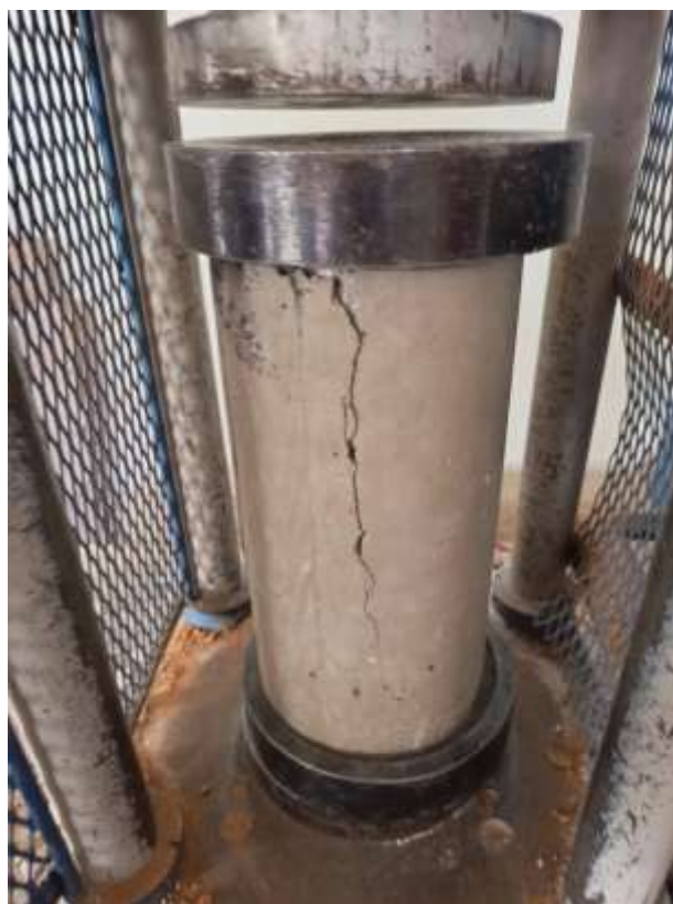
Fotografía 8. Rotura de briquetas
