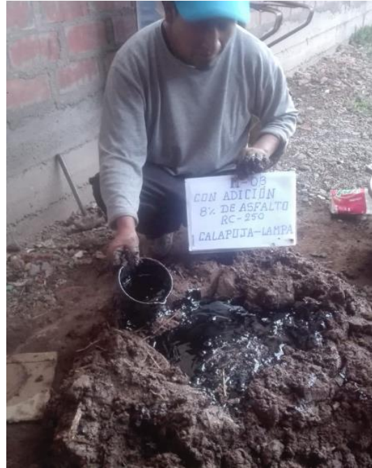
FOTO N° 14 muestra 8% de asfalto
