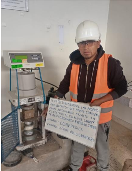
Foto N° 22 resistencia ala compresión
