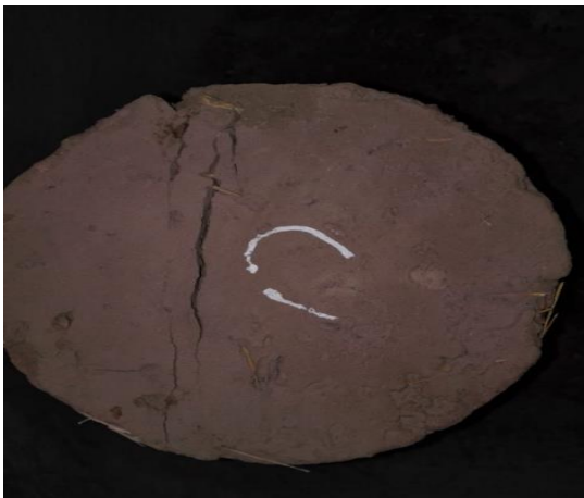
Foto N° 30 adobe patrón sometida a tracción
