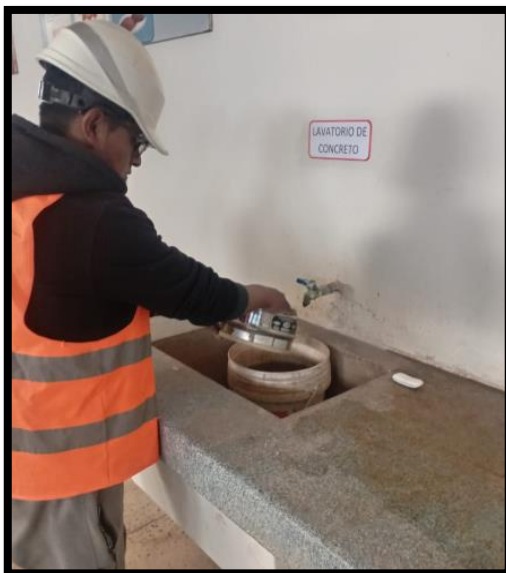
Foto N° 20 Lavado del suelo
