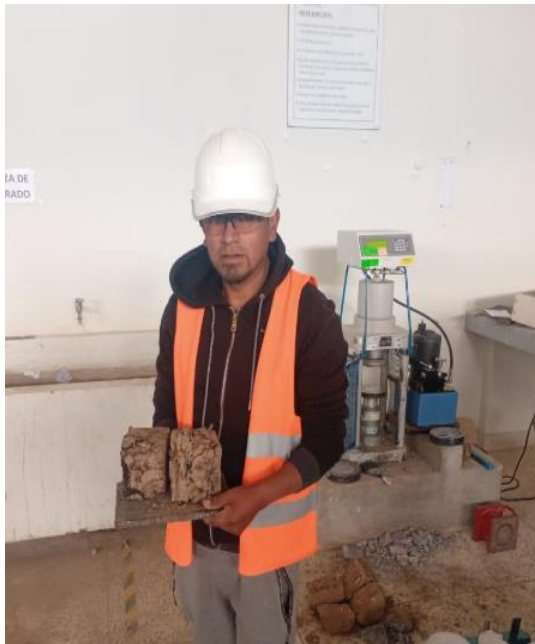
Foto N° 24 rotura a compresión
