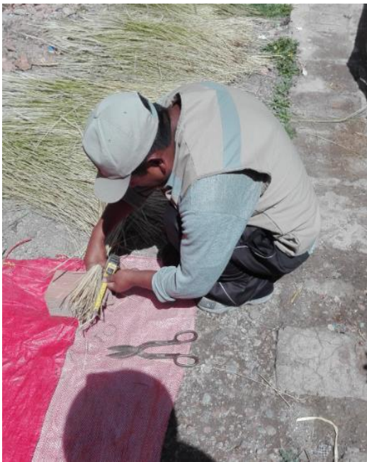
FOTO N° 03 medición de la paja 10cm
