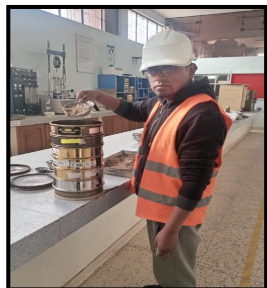
Foto N° 21 Tamizado del material
