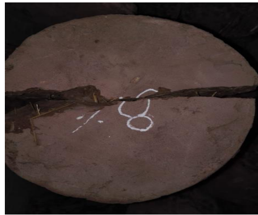
Foto N° 29 sometida a tracción con 8%
