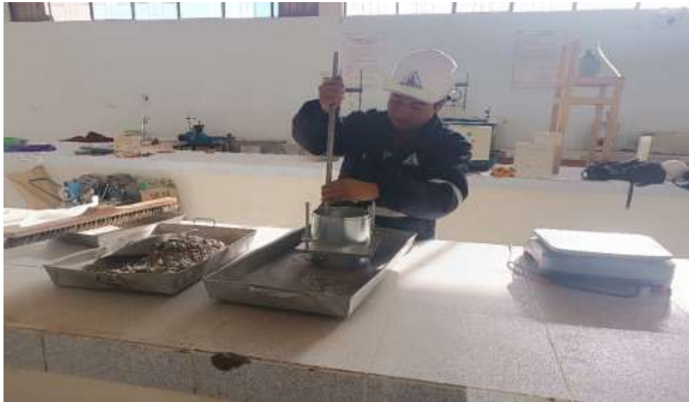
Fotografía 05. Se muestra el peso unitario
